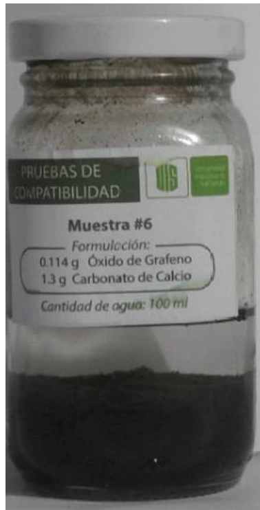
Figura 20. Muestra de \text{CaCO}_3 y OG después de 30 días.
