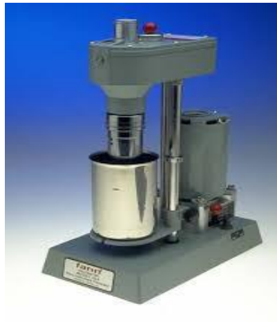
Figura 21. Modelo del viscosímetro Fann 35 A.
