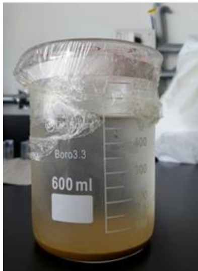
Figura 14. Hidrólisis del óxido de grafito.
