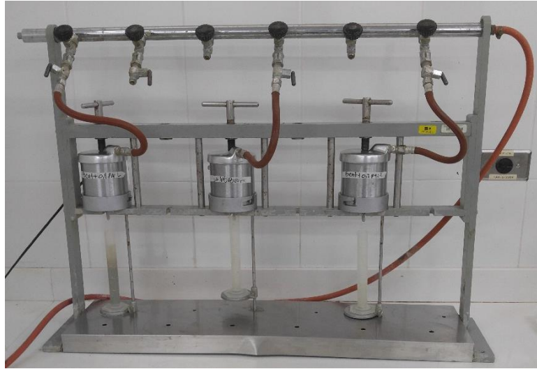
Figura 22. Filtro prensa API de baja presión
