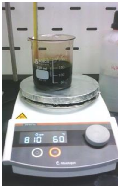
Figura 12. Oxidación en fase líquida del grafito.
