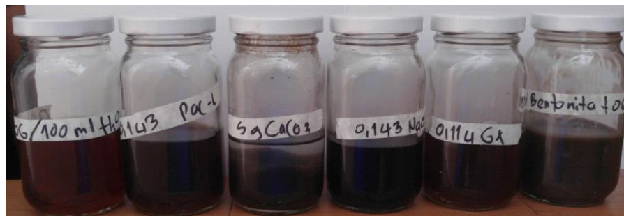
Figura 18. Muestras para las pruebas de compatibilidad después de 10 días.
