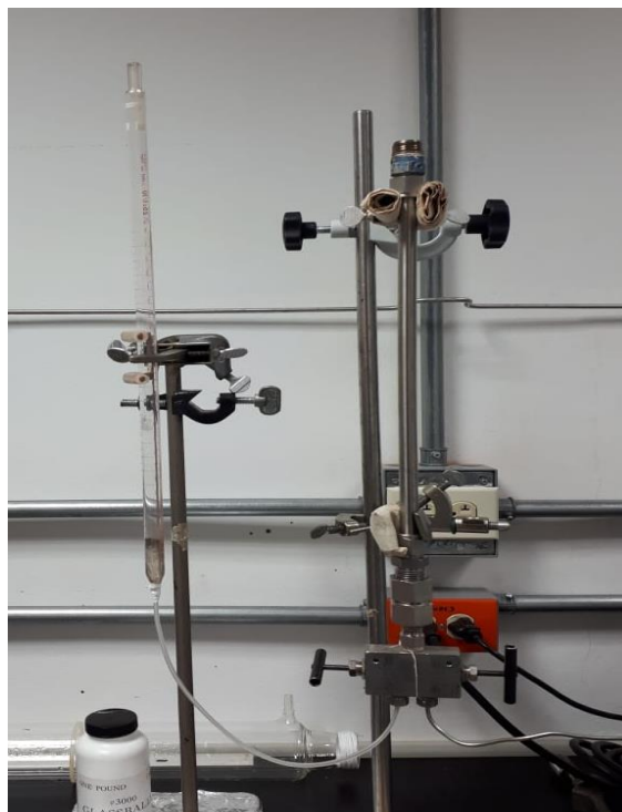
Figura 16. Montaje utilizado para determinar la viscosidad aparente de la espuma generada con el surfactante D.
