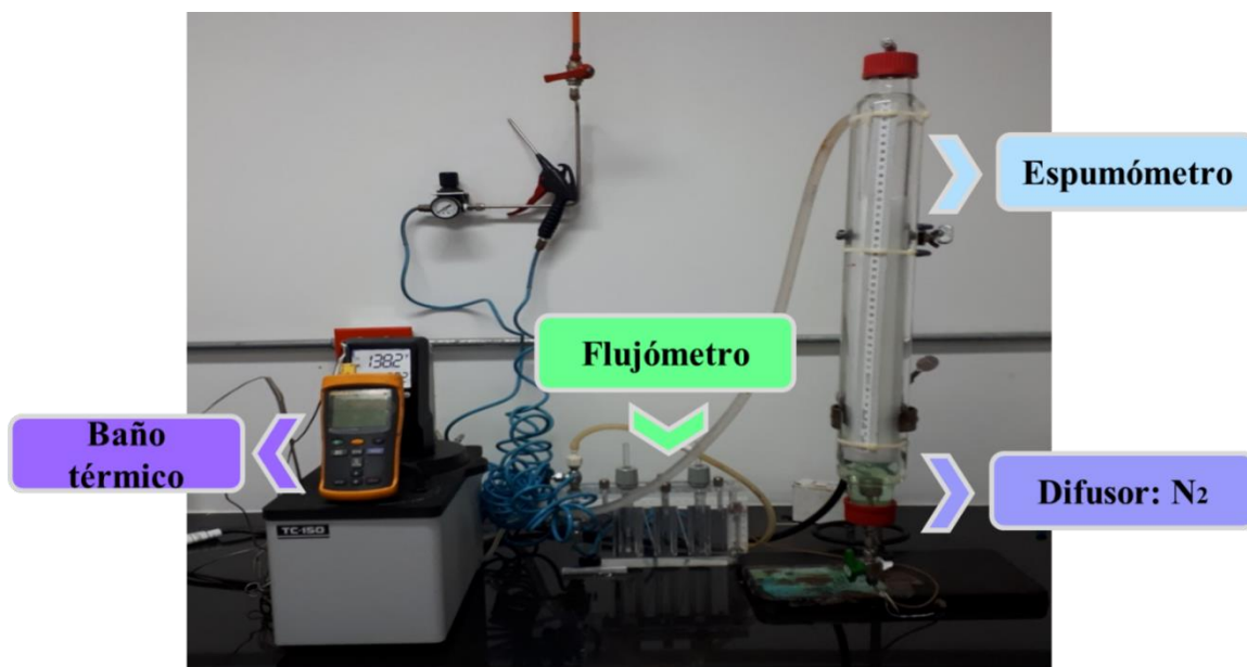
Figura 9. Espumómetro. Laboratorio Química de Producción, Instituto Colombiano del Petróleo.
