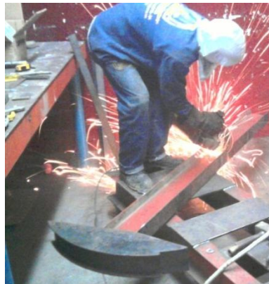
Figura 72. Construcción de la viga viajera.
