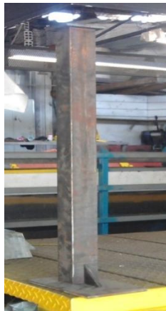
Figura 67. Poste soporte de la viga viajera.
