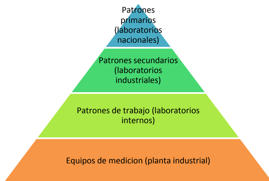
Figura 3. Trazabilidad de un equipo de medición.
