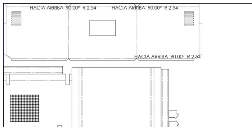
Figura 45 Distribución para el corte de piezas en lámina de 8 x 4 pies
