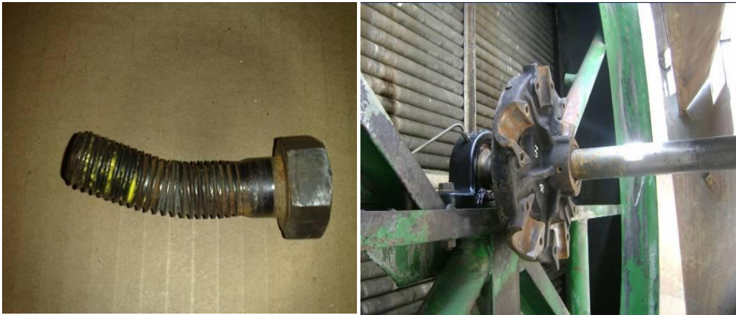
Figura 20: Tornillo de Hub Torcido. Máquina 3 Refrigerante. Estación Suerte
