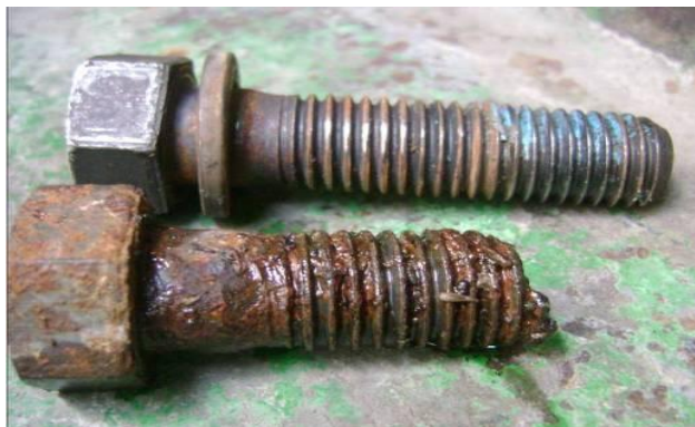
Figura 26: Tornillo de Hub Deteriorado.
