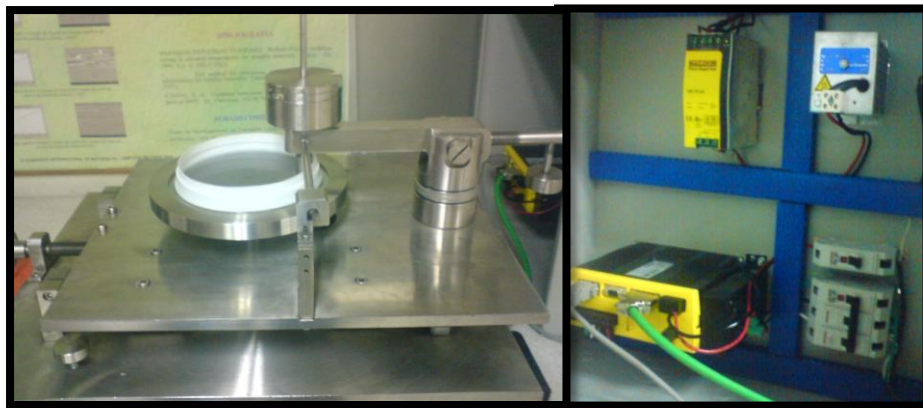
Figura 10. Montaje empleado para la prueba Pin-On-Disk (izquierda) y multiplex del servomotor (derecha) que permite controlar el ensayo.
