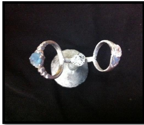
Figura 23. Prototipo 3, Colada con vacío y prototipo con gemas
