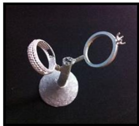
Figura 22. Prototipo 2, Colada con vacío y prototipo sin gemas
