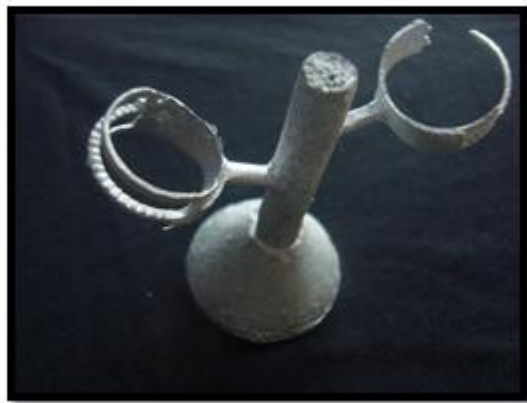
Figura 21. Prototipo 1, colada sin vacío y prototipo sin gemas
