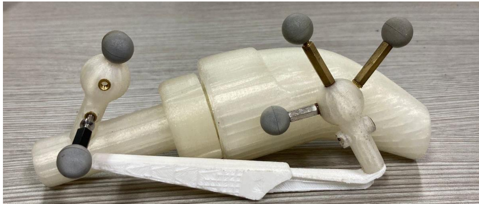
Figura 21. Rigid Bodies de un Artroscopio y un Palpador. Fuente: Autor del proyecto.
