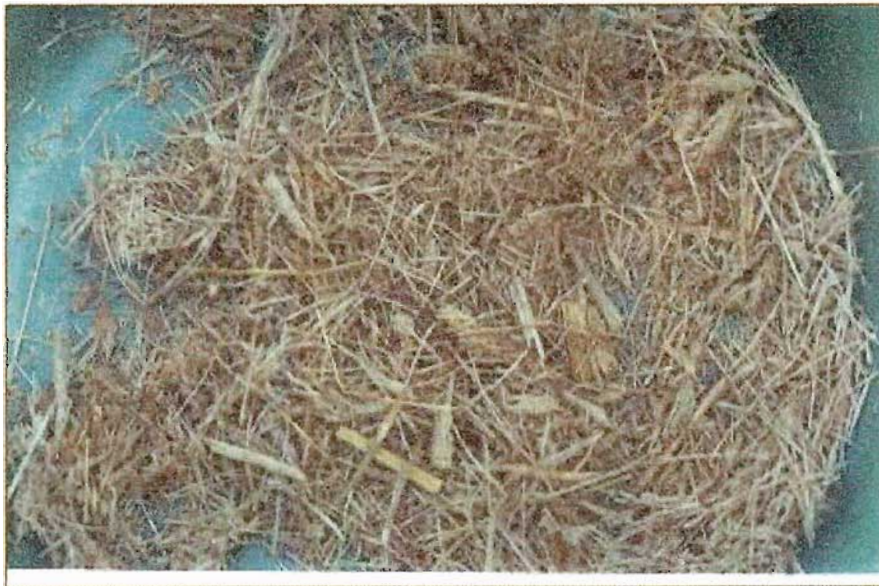
Figura 21. Reducción del tamaño de partícula del sustrato.
