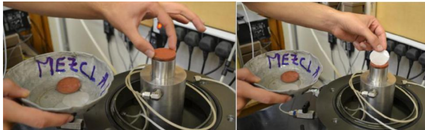
Figura 4. Colocación piedras porosas
