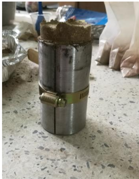
Figura 13. Probeta, fabricación de la muestra
