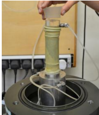
Figura 9. Montaje aditamento para conexión al pedestal
