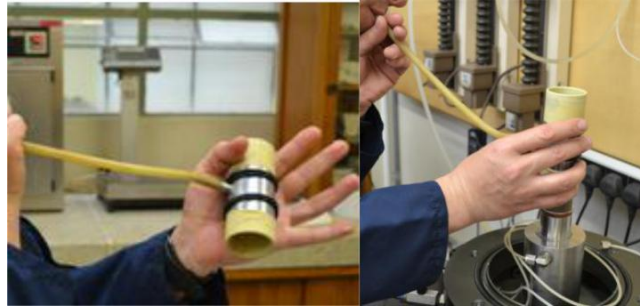
Figura 5. Montaje de la membrana en la muestra
