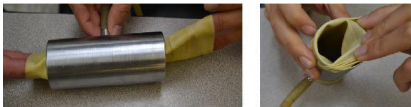
Figura 2. Colocación membrana látex
