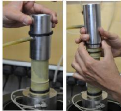
Figura 7. Sellado de la membrana en la muestra
