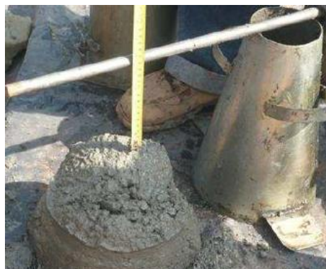
Figura 16. Medición de asentamiento
