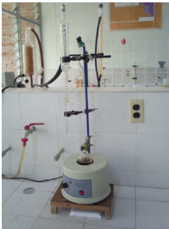
Figura 26. Montaje realizado en la preparación de la tiazolidinona
