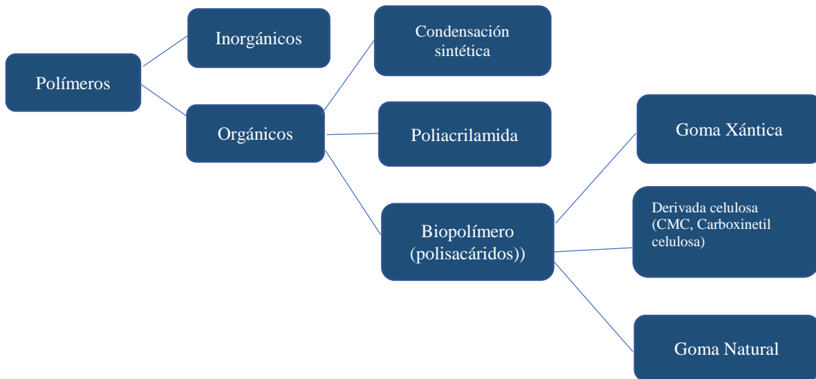
Figura 3. Clasificación de los polímeros usados en la industria (Adaptada de Stright, J.2008).
