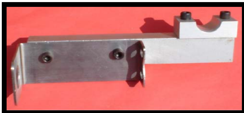
Figura 27. Construcción del conjunto del soporte inferior.
