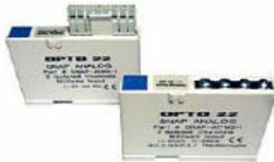
Figura 36. Módulos de entrada/salida.
