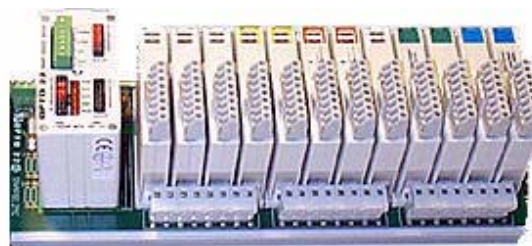
Figura 37. Rack Standard con módulos I/O soportados en el riel DIN.
