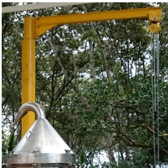
Figura 16. Columna y polipasto manual.
