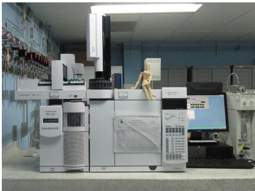
Figura 26. Cromatógrafo de gases de alta resolución Agilent Technologies 7890 A, acoplado a espectrómetro de masas Agilent Technologies 5975C,
