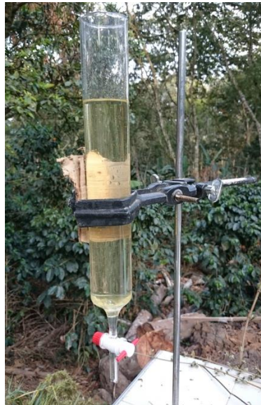
Figura 22. Recolección y decantado del aceite extraído.
