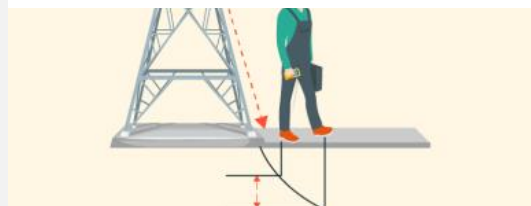
Figura 12 Tensión de paso
