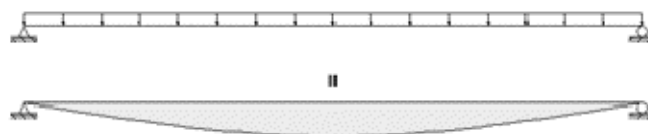
Figura 21. Viga simplemente apoyada y esquema de momento flector
