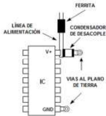
Figura 41. Esquema de desacople para los dispositivos sensibles
