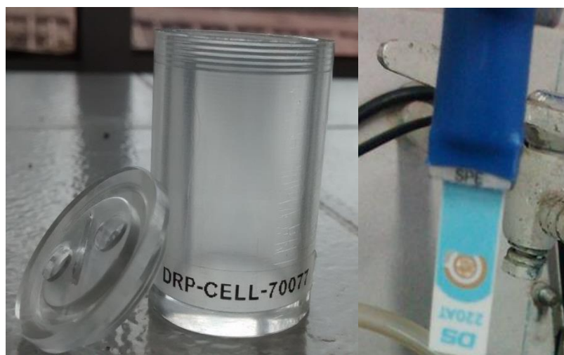
Figura 9. A la izquierda celda de acrílico. A la derecha electrodo serigrafiado de oro
