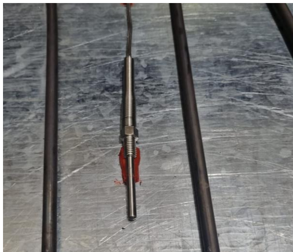
Figura 35. Termocuplas tipo k para medición de hasta 800°C
