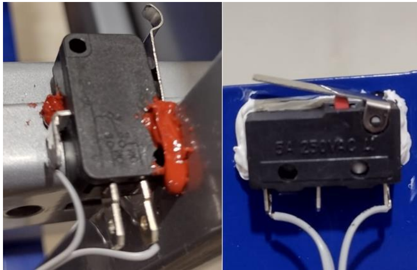
Figura 38. Sensores de compuertas
