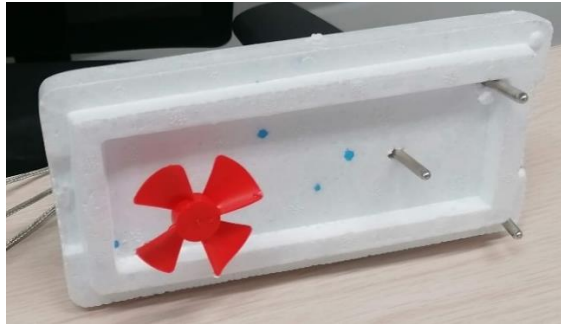
Figura 19. Montaje de termocuplas
