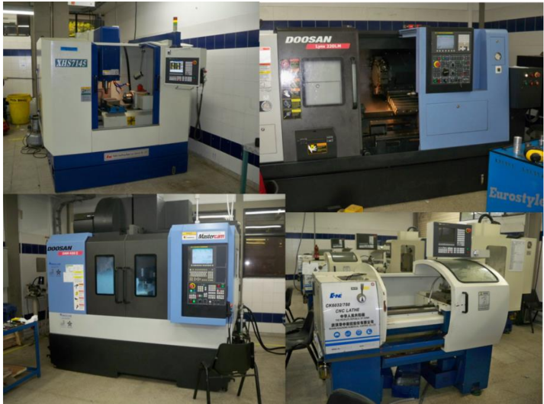
Figura 113. Centros de mecanizado “CNC” utilizados en la fabricación de las piezas diseñadas para la caja de cambios.
