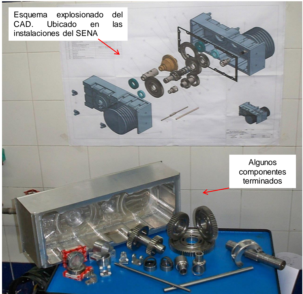
Figura 125. Muestra del producto final del maquinado de algunos de los componentes de la caja de cambios.
