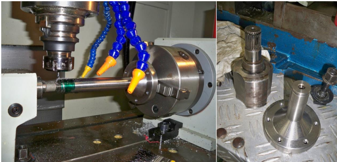
Figura 124. (Izquierda). Eje extensión para el diferencial y (Derecha). Bujes para los ejes de los motores eléctricos
