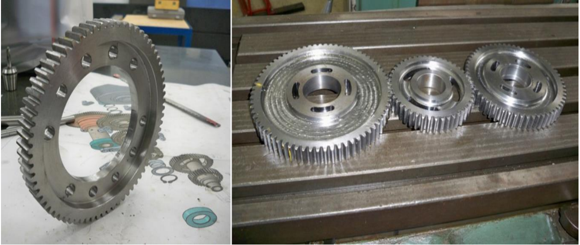
Figura 120. Resultado del maquinado de los engranajes de la caja de cambios
