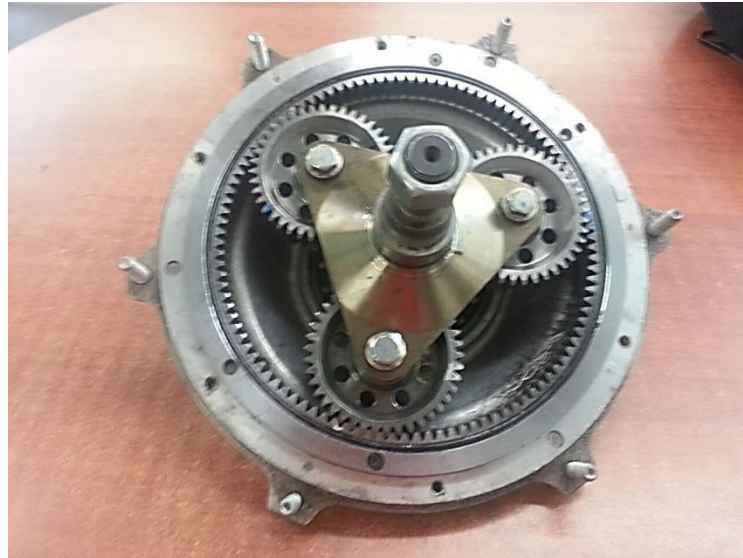
Figura 29. Chasis modificado para instalar la caja de cambios
