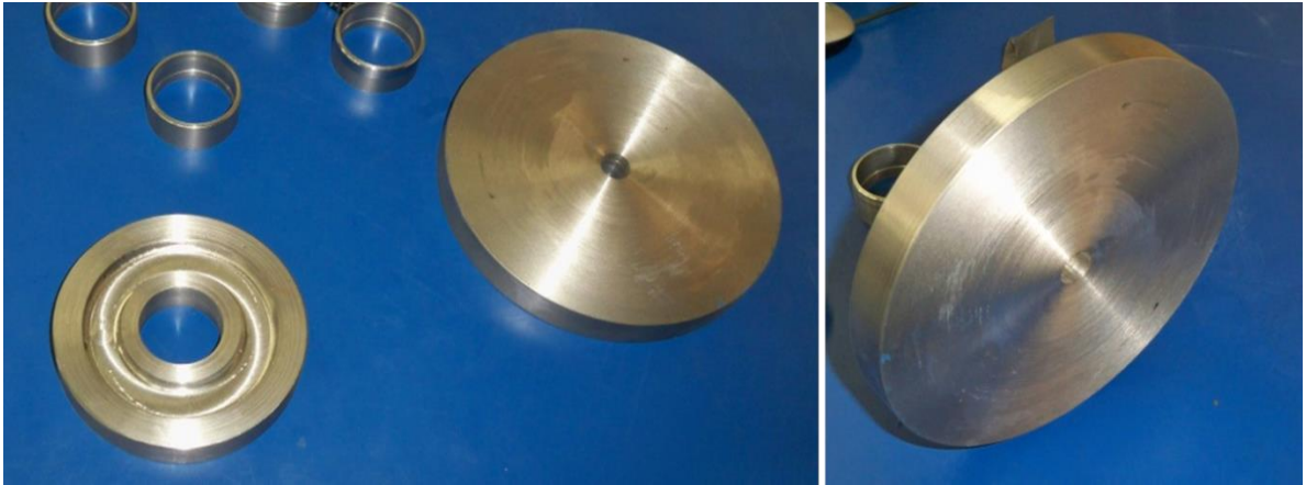
Figura 118. Maquinado inicial de la materia prima para los engranajes
