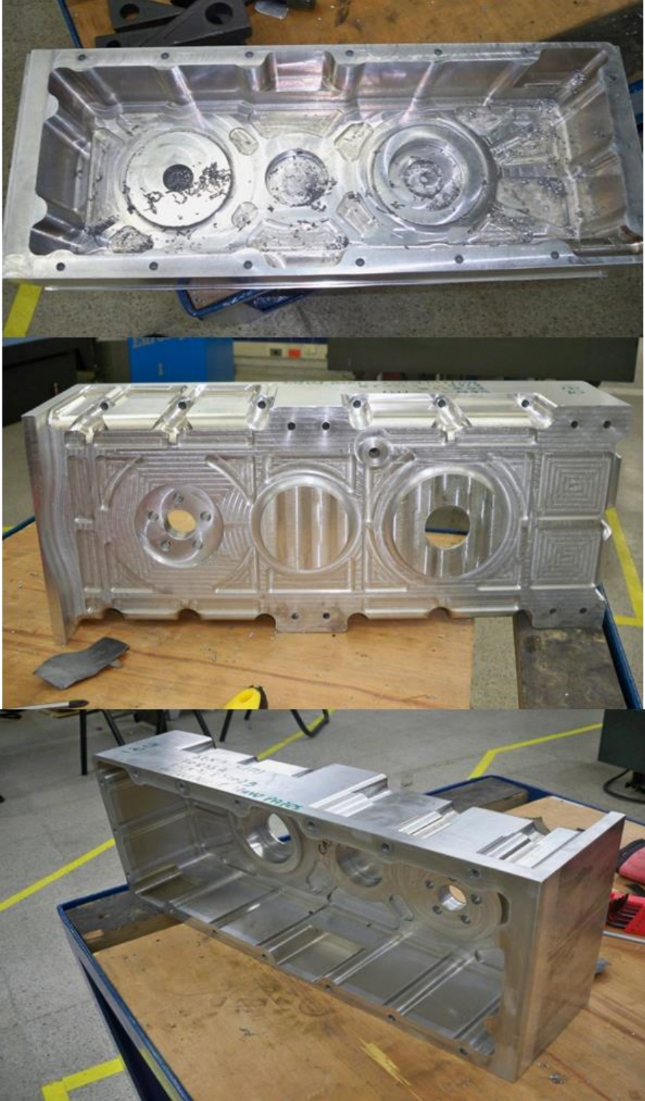
Figura 117. Resultado del maquinado de la Carcasa de la caja de cambios
