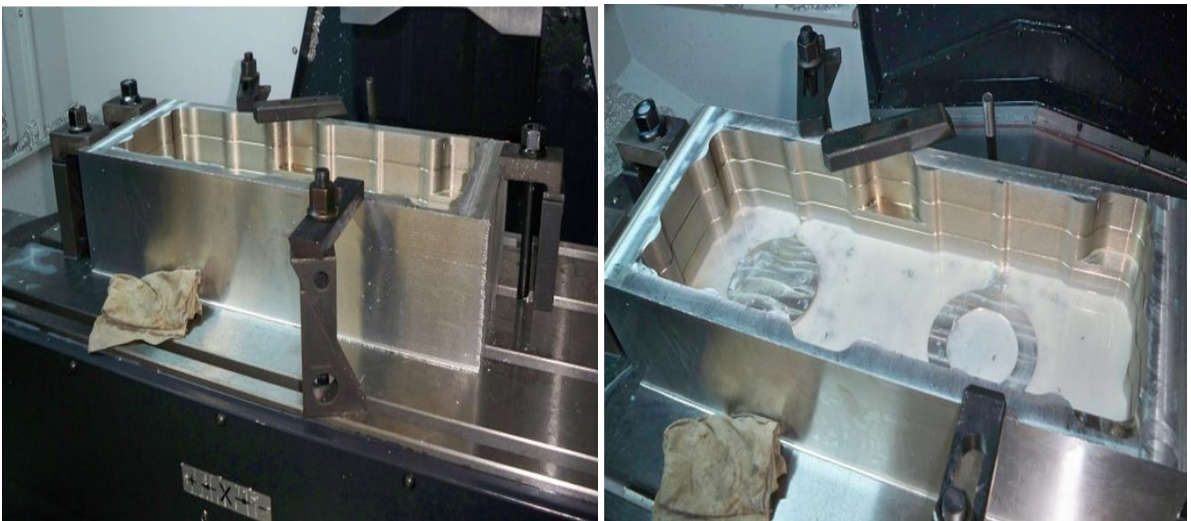
Figura 116. Maquinado interior de la carcasa de la caja de cambios de cambios. (Máquina de Control Numérico Computarizado - CNC )
