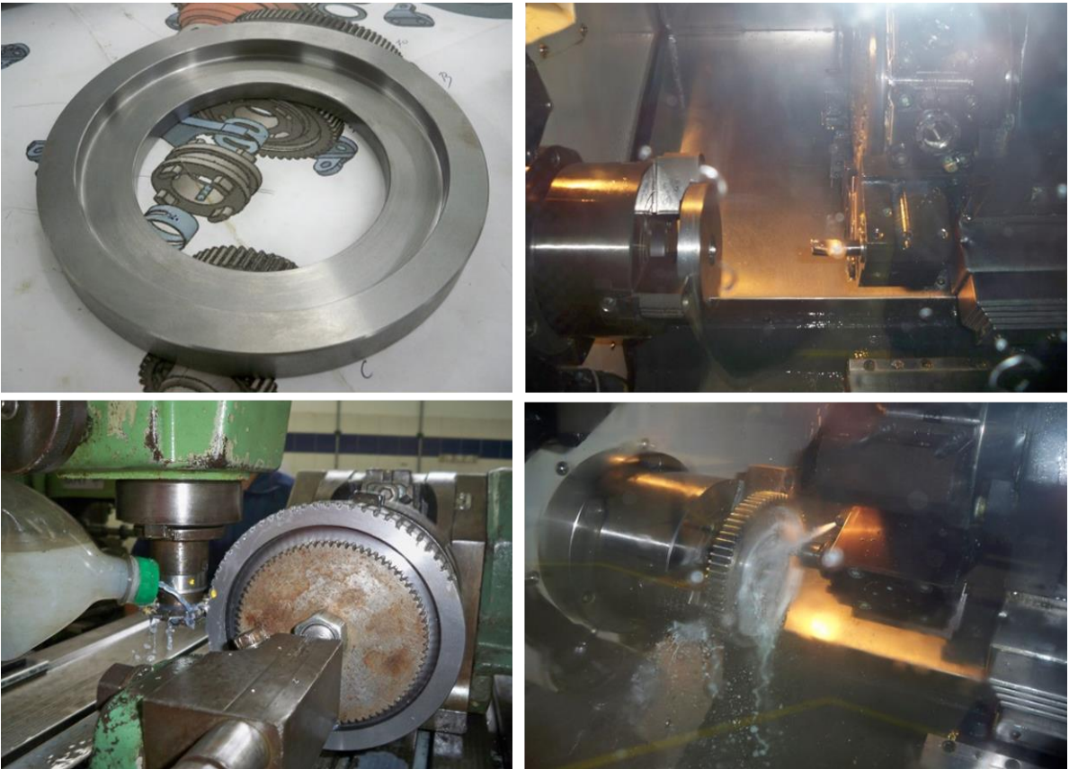
Figura 119. Maquinado de los engranajes. (Uso de fresadora convencional y torno CNC)
