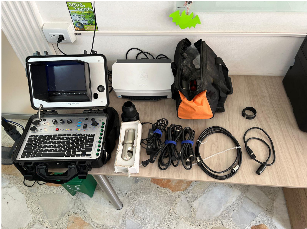
Figura 4-Equipos de monitor y cámara de inspección.
