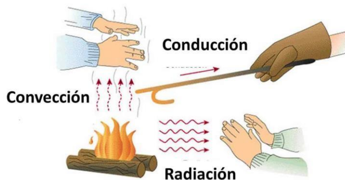
Figura 2. Métodos de transferencia de calor.
