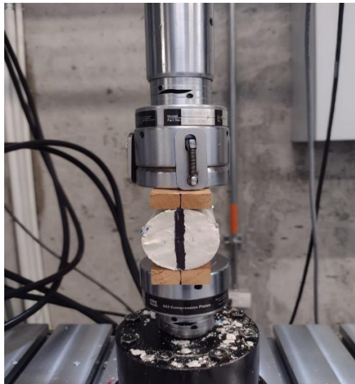
Figura 32. Posición de una probeta para la prueba de tracción
