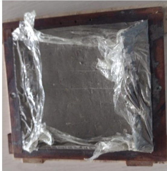
Figura 20. Probeta secando en molde
