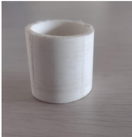
Figura 14. Molde de probeta cilíndrica
