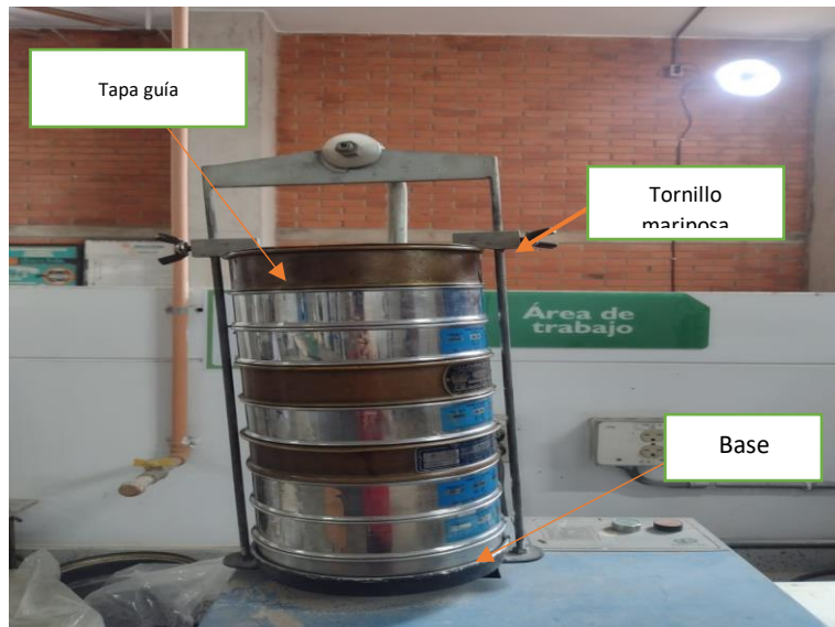
Figura 11. Agitador vibratorio de tamices
