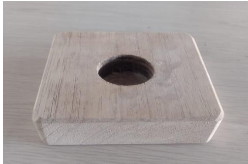
Figura 13. Base para molde de probetas cilíndricas
