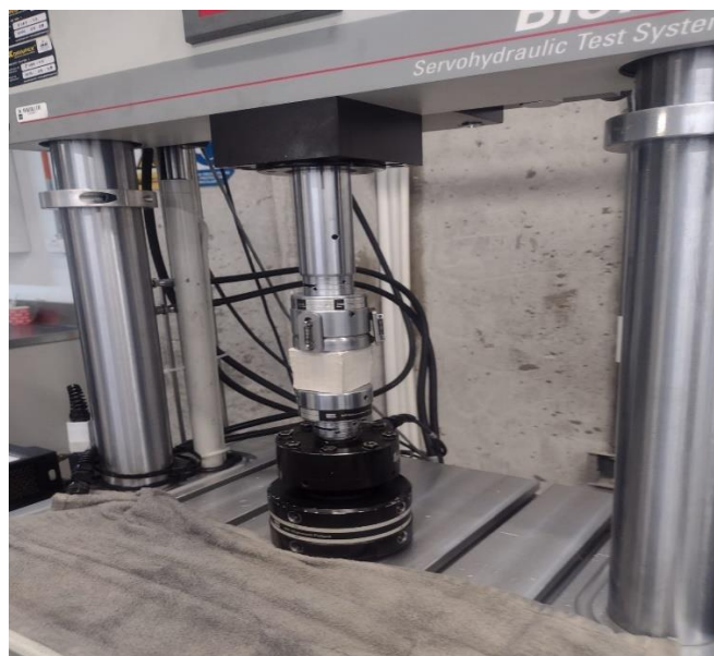
Figura 30. Posición de una probeta cubica para la prueba de compresión
