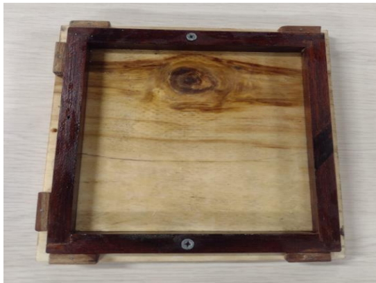
Figura 12. Molde para probetas cuadradas
