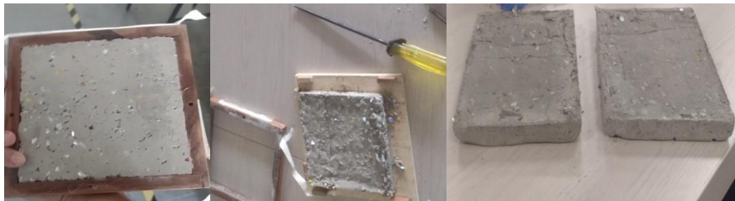
Figura 21. Proceso de desmoldeo
