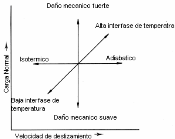
Fig. 8. Diagrama combinado de carga y velocidad de deslizamiento en el proceso de desgaste deslizante en metales.
