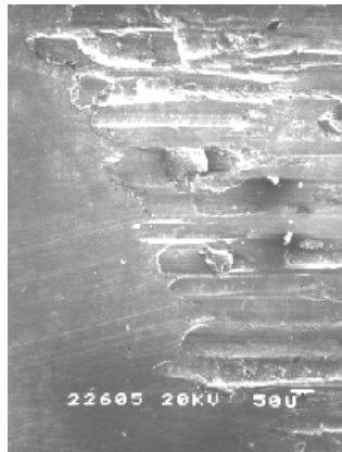
Figura 2. Abrasión-adhesión. Final de huella
