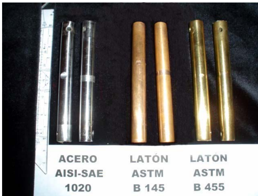
Figura 19. Estado superficial final de las probetas sometidas a desgaste.
