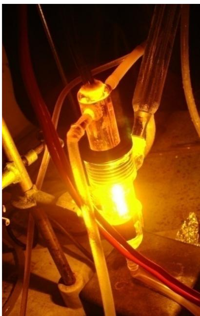
**Figura 3.6** Reactor empleado en la oxidación de AT
