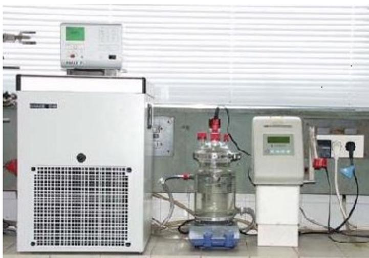
**Figura 3.4** Reactor empleado en la degradación de luminol
