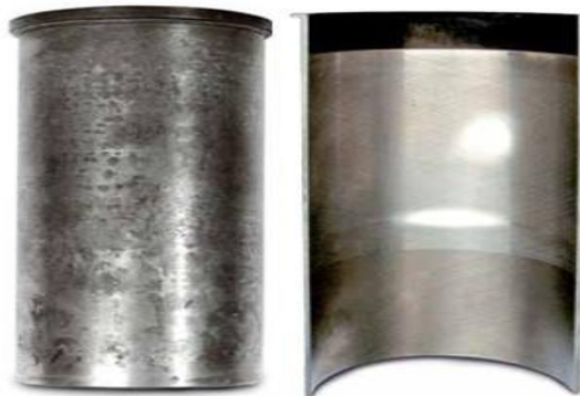
Figura 3.7. Desgaste irregular del cilindro
