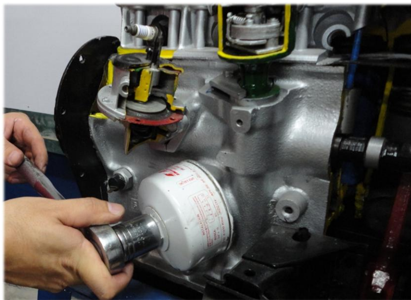
Figura 9.9 Desmote del filtro de aceite
