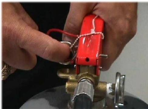
Figura 2. Pasador de seguridad del extintor.
