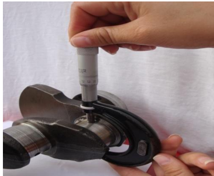
Figura 4 Medición de las muñequillas del cigüeñal
