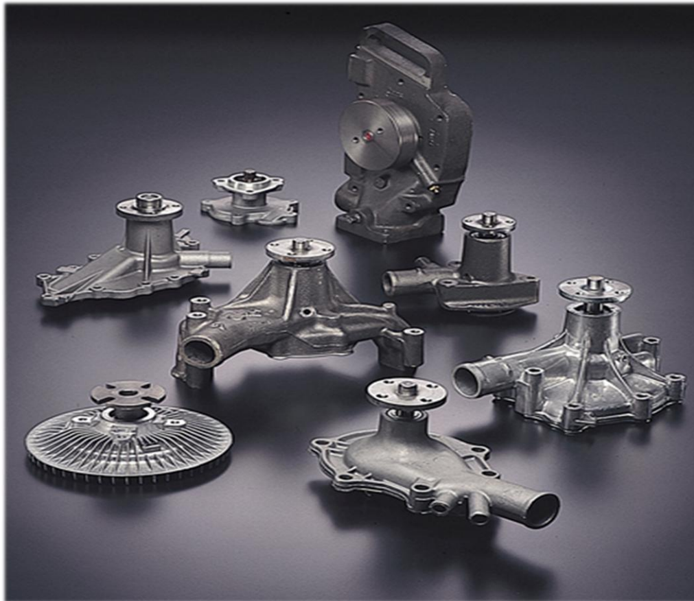
Figura 10.1 Bomba de Agua
