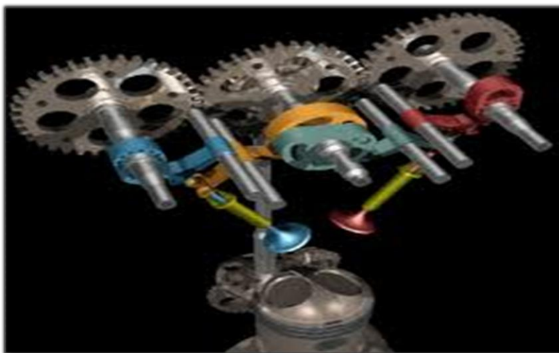
Figura 5.6. Sistema de distribución por engranajes
