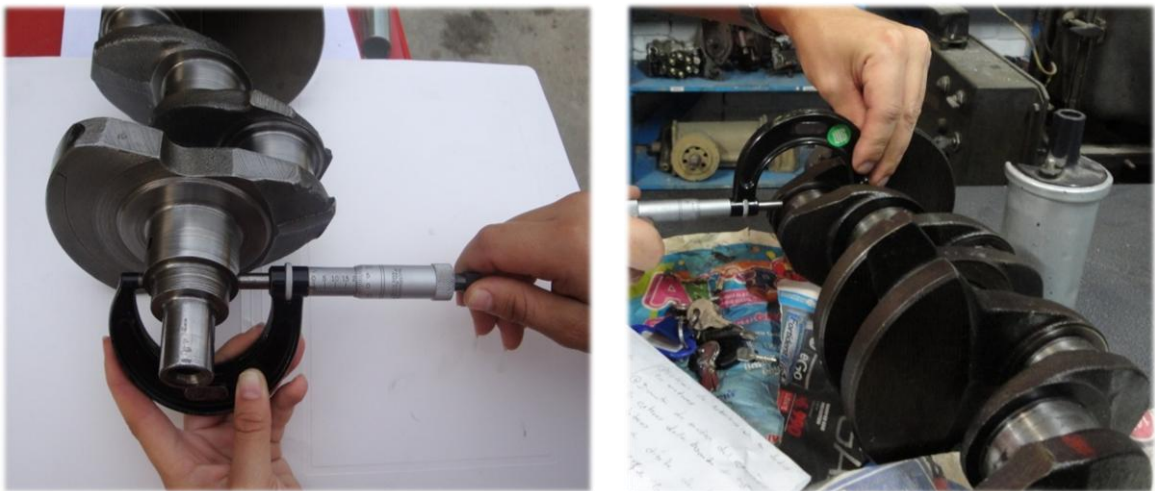
Figura 2.13 Toma de medidas con micrómetro de exteriores en cigüeñal.
