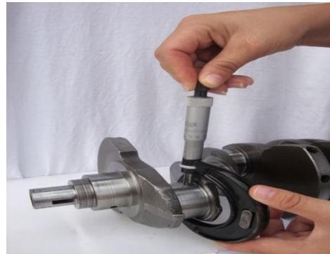
Figura 4 Medición de las muñequillas del cigüeñal
