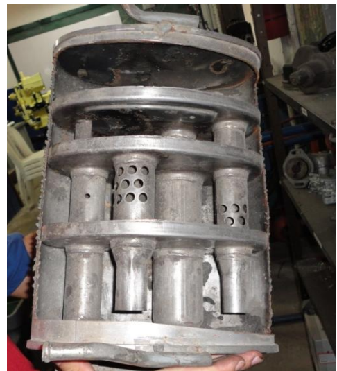
Figura 3. Figura 3. Filtro de aire y silenciador del sistema de admision y escape
