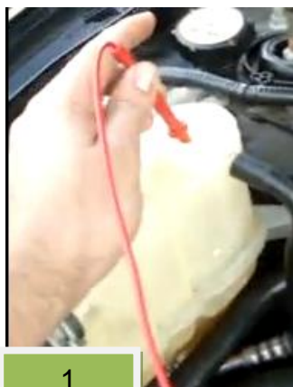
Figura 5. Medición del pH del liquido refrigerante
