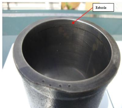
Figura 2. Reborde superior en el cilindro.
