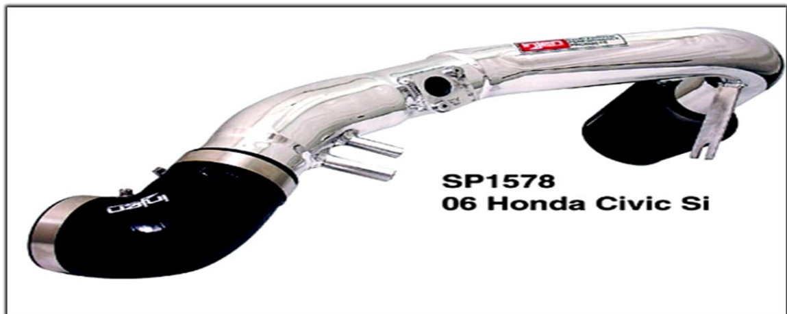
Figura 6.2 Tubos y mangueras del sistema de filtración de aire
