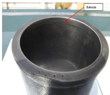
Figura 3.11. Reborde superior en el cilindro.
