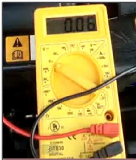
Figura 10.12 Medición del pH del líquido refrigerante (Paso 3)
