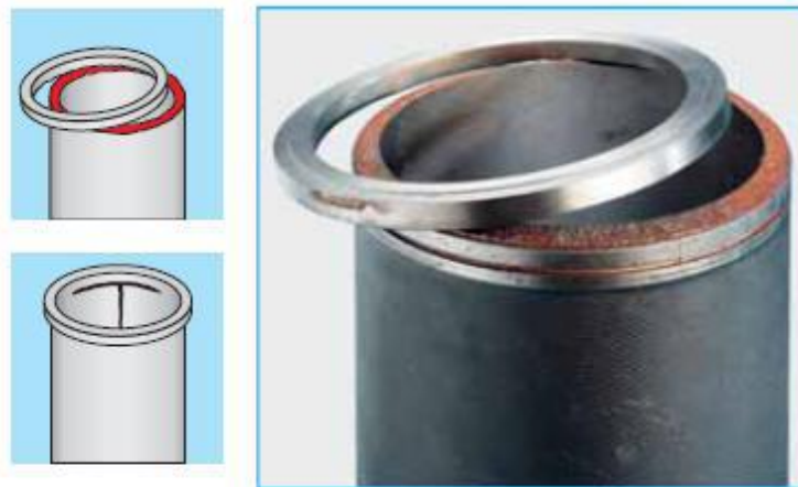
Figura 3.6. Rotura de collarines de camisa
