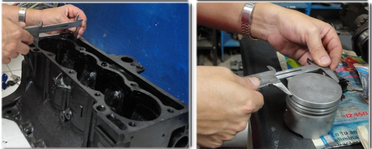
Figura 4.8 Medición del diámetro del cilindro y pistón
