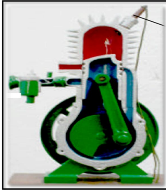
Figura 4.9 Motor de dos tiempos didáctico en corte
