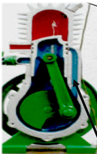
Figura 6. Motor de dos tiempos didáctico en corte
