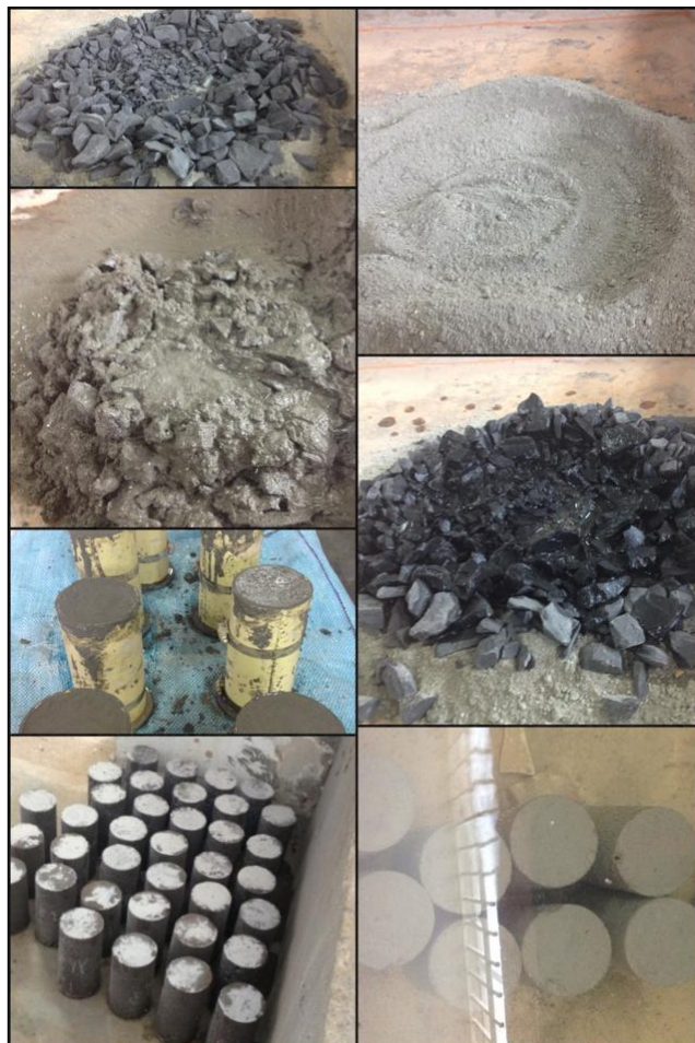
Figura 24: Proceso de elaboración de las probetas experimentales.
