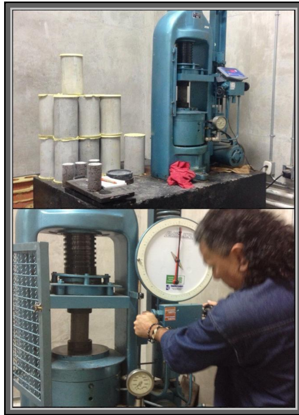
Figura 25: Pruebas de resistencia a la compresión realizadas a las probetas experimentales.
