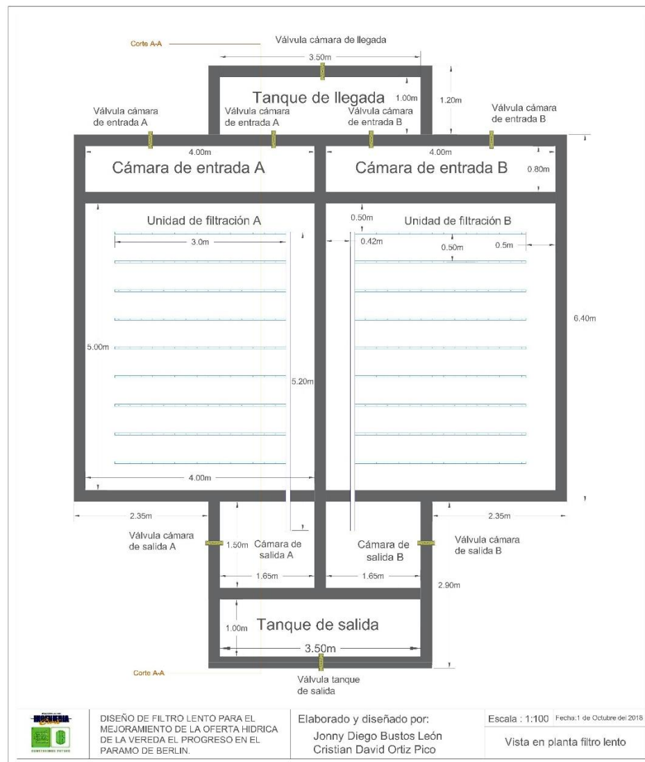
Figura. Vista en planta del filtro lento.
