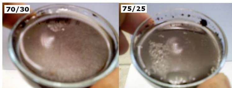
Fotografías 2. Prueba cualitativa de estabilidad de emulsiones O/W
