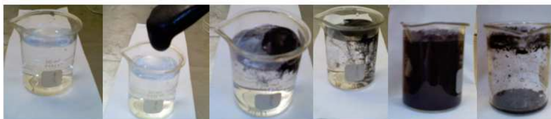
Fotografías 3. Evidencia de inestabilidad cualitativa de la emulsión 75/25
