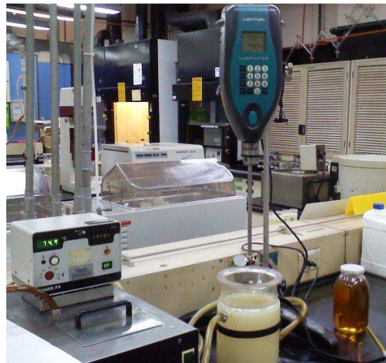
Fotografía 1. Sistema de preparación de emulsiones de agua en aceite O/W con medición de torque
