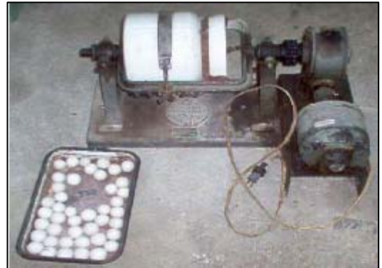
FIGURA 2. Molino de bolas cerámicas.
