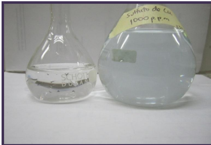
Figura 14. Valoración cualitativa de la prueba de adsorción de sulfato de cobre de 1.000 ppm.
