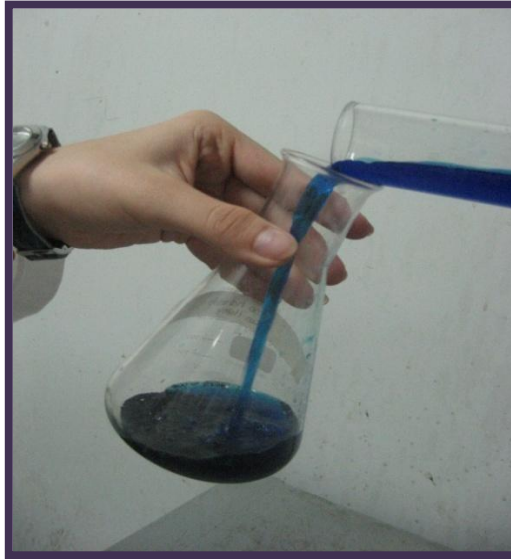
Figura 13. Adición de azul de metileno al adsorbente preparado
