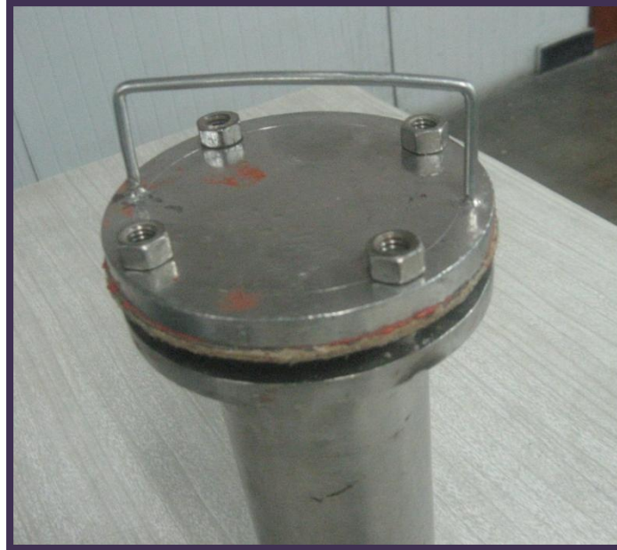
Figura 9. Reactor utilizado para la modificación química de la superficie mediante tratamiento térmico
