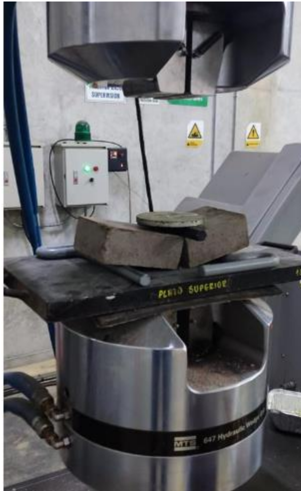
Ilustración 12. Montaje ensayo a flexión de ladrillos arena - PET.
