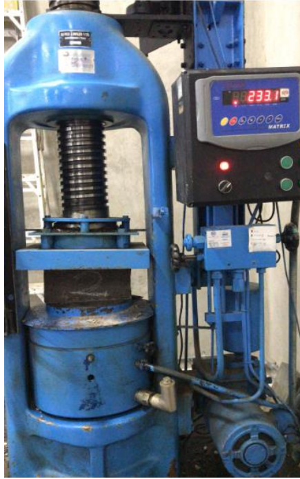
Ilustración 9. Ensayo a compresión posición estampa.
