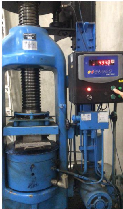
Ilustración 10. Ensayo a compresión en posición sogá.
