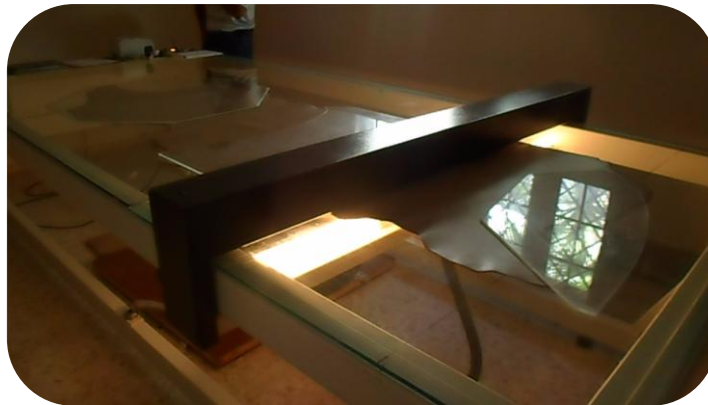
Ilustración 20. Medición de la piel
