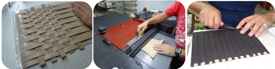
Ilustración 26. Fabricación de las tiras de cerraje para los tejidos
