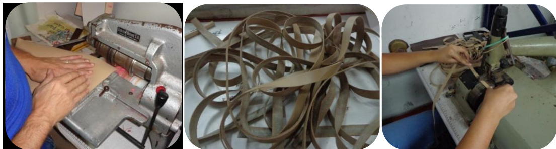
Ilustración 24 Corte manual, troquelado de las piezas y residuo de corte
