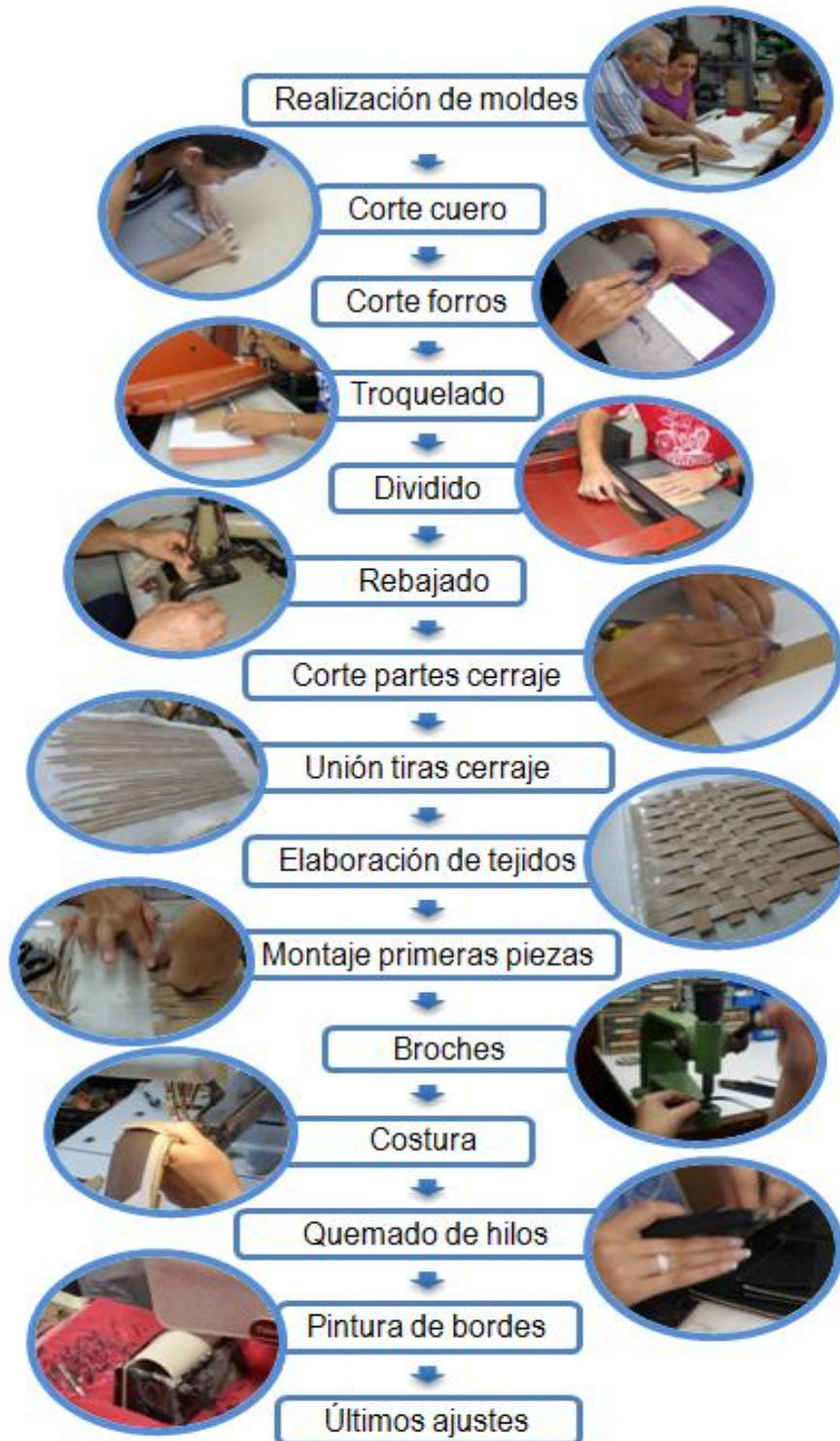
Ilustración 22. Esquema del proceso de fabricación
