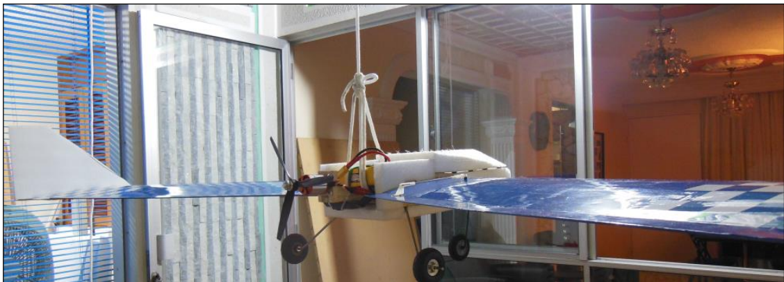
Figura 26. Balanceo del modelo original construido para realizar la prueba del concepto. Fuente: Autor
