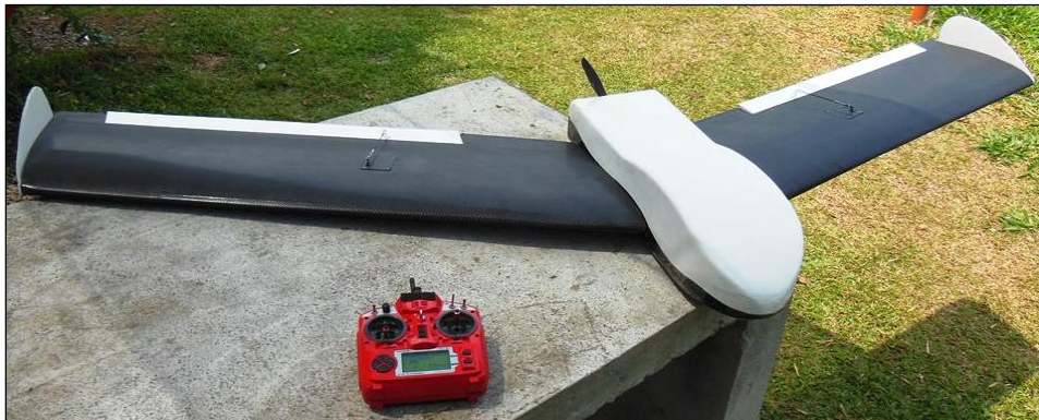
Figura 77. Prototipo 3 alternativo con recubierta del fuselaje hecha en fibra de vidrio. Fuente: Autor
