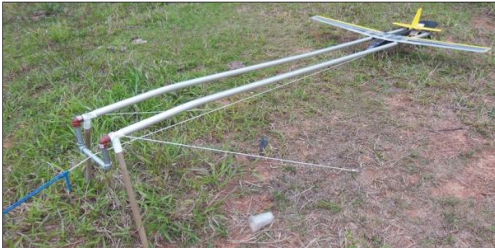
Figura 29. Sistema de catapulta para lanzamiento de Planeadores sin propulsión. Fuente: Autor
