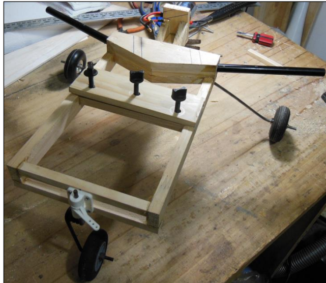
Figura 22. Tren de aterrizaje implementado en el prototipo preliminar. Fuente: Autor
