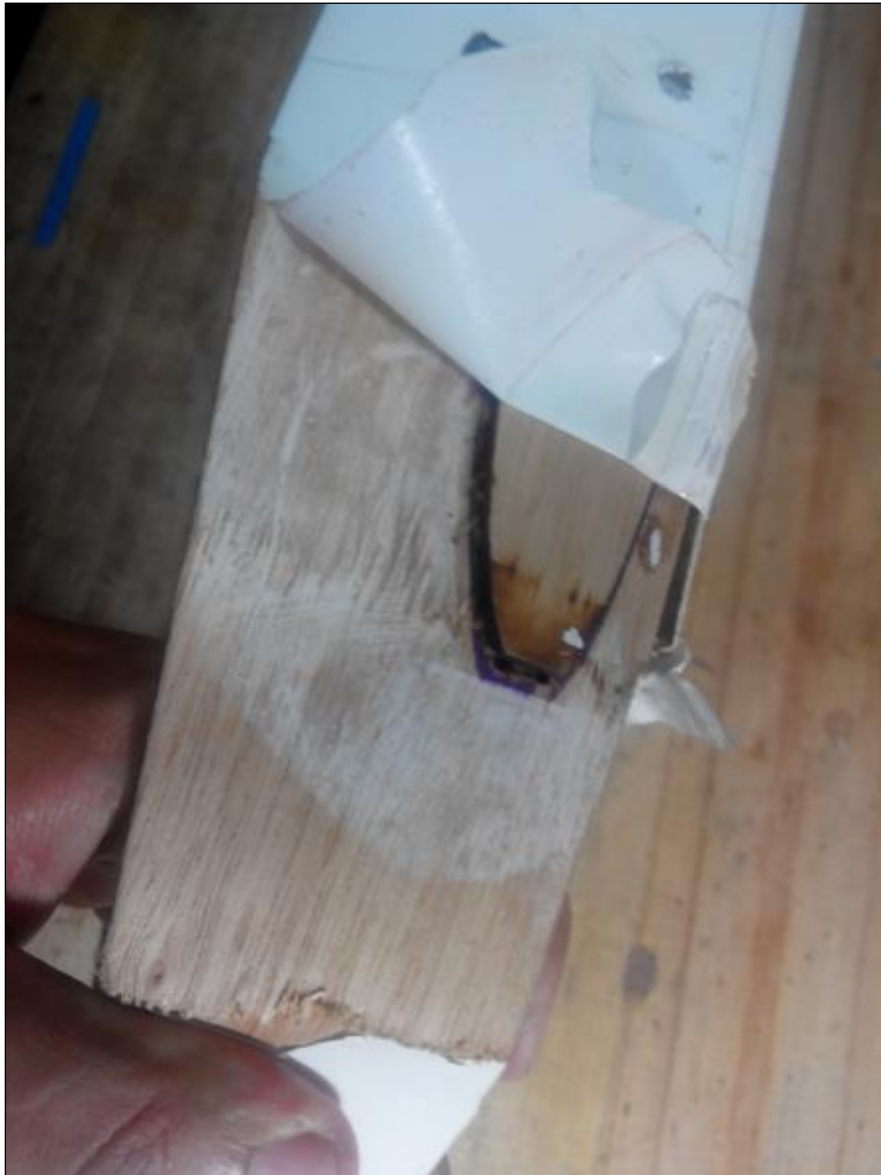
Figura 56. Falla producida en el borde estructural de refuerzo lateral ubicado para concordar con el perfil alar. Fuente: Autor
