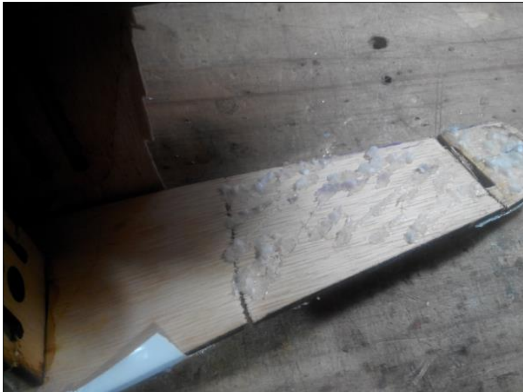
Figura 55. Daño estructural del fuselaje luego de un accidente. Fuente: Autor
