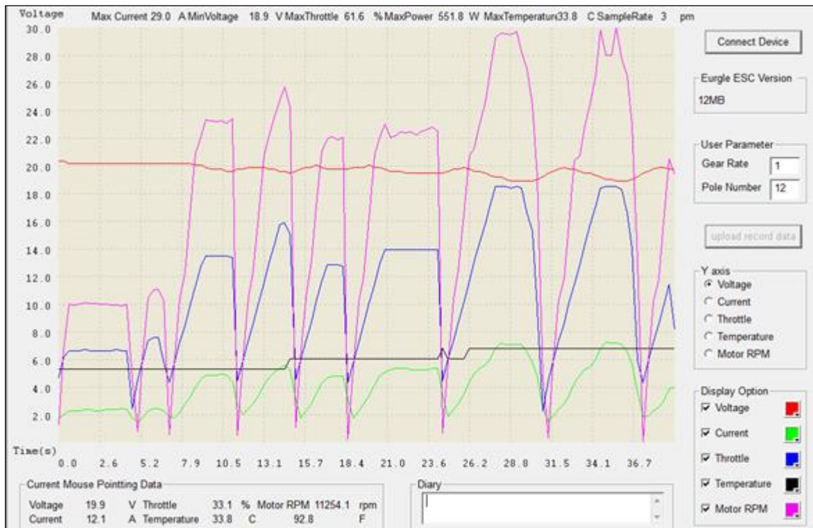
Figura 43. Potencia real medida del modelo. Fuente: Autor
