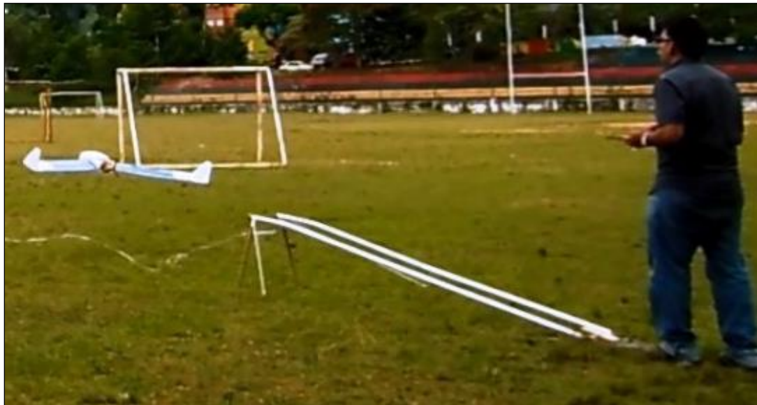
Figura 30. Prueba de concepto de la catapulta utilizada para lanzamiento de los prototipos Arpegio I y Arpegio II. Fuente: Autor
