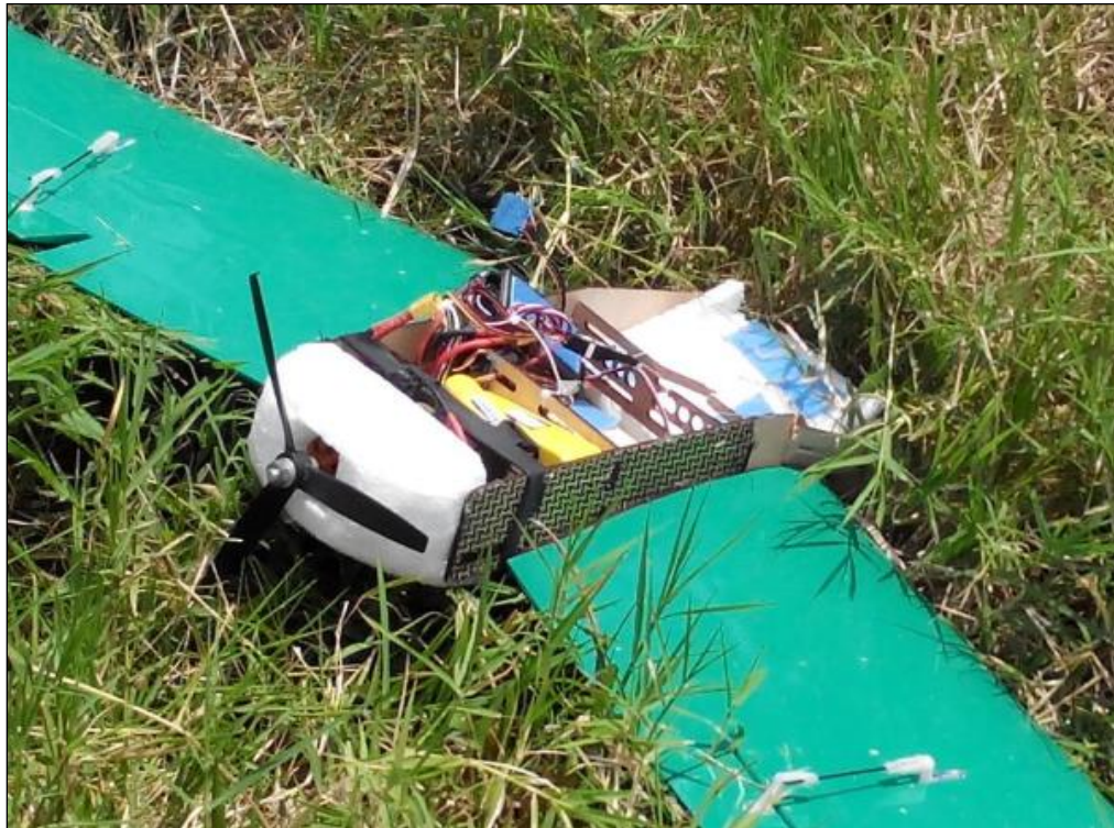
Figura 57. Falla frontal en el modelo producido por el choque a alta velocidad. Fuente: Autor
