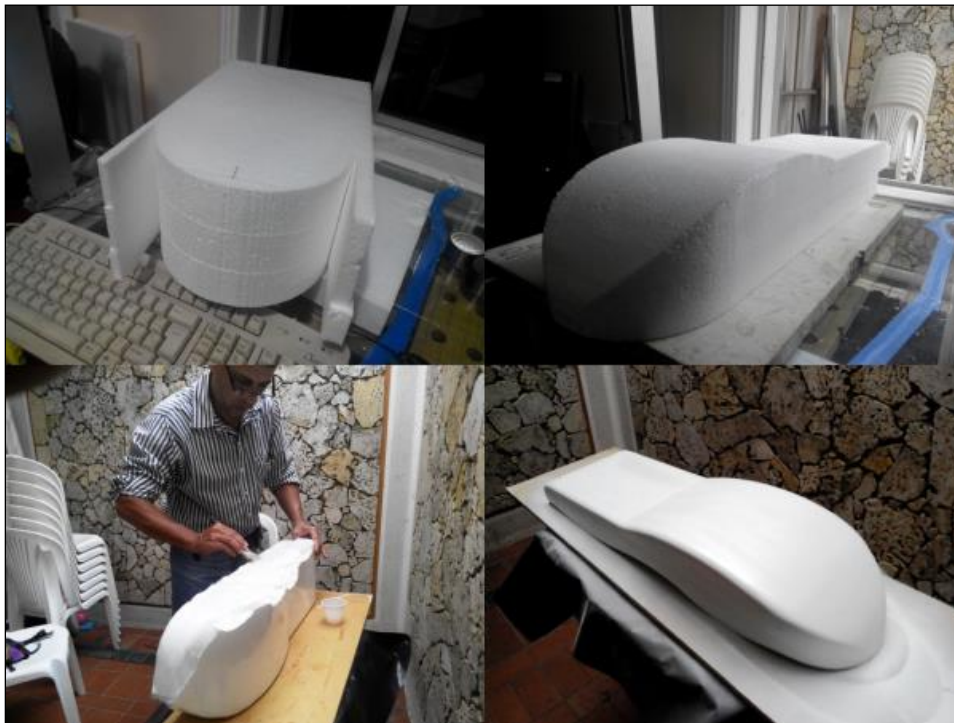
Figura 75. Proceso de construcción de la cubierta del modelo. Fuente: Autor
