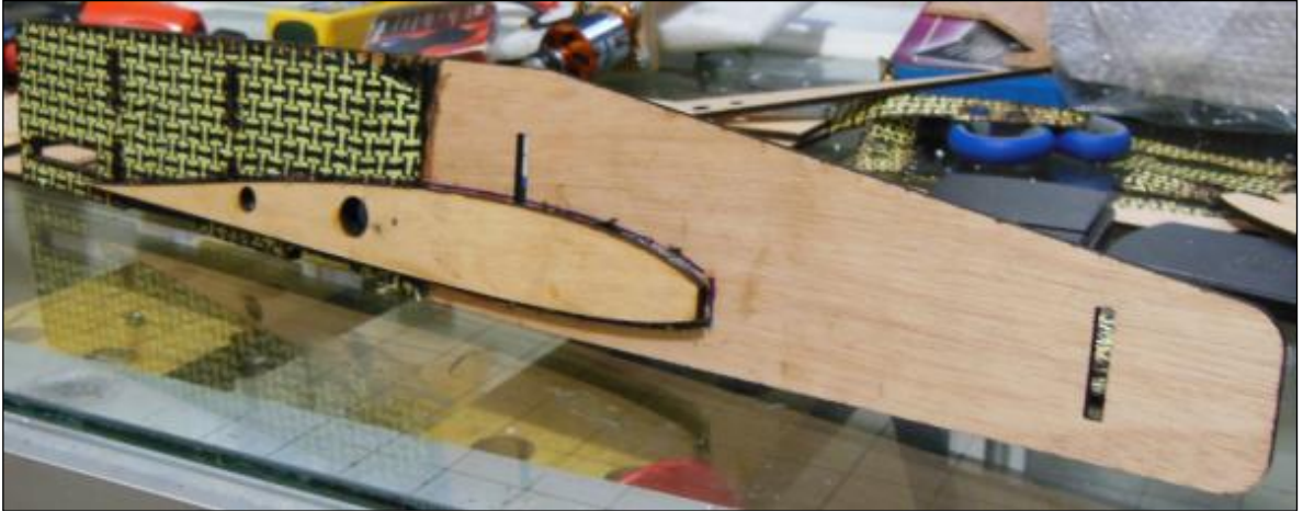
Figura 54. Refuerzo estructural realizado con la tela de kevlar con fibra de carbono. Fuente: Autor
