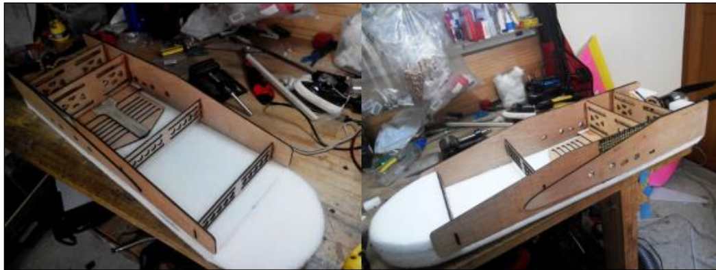
Figura 76. Ensamblaje con EPP en el fuselaje. Fuente: Autor
