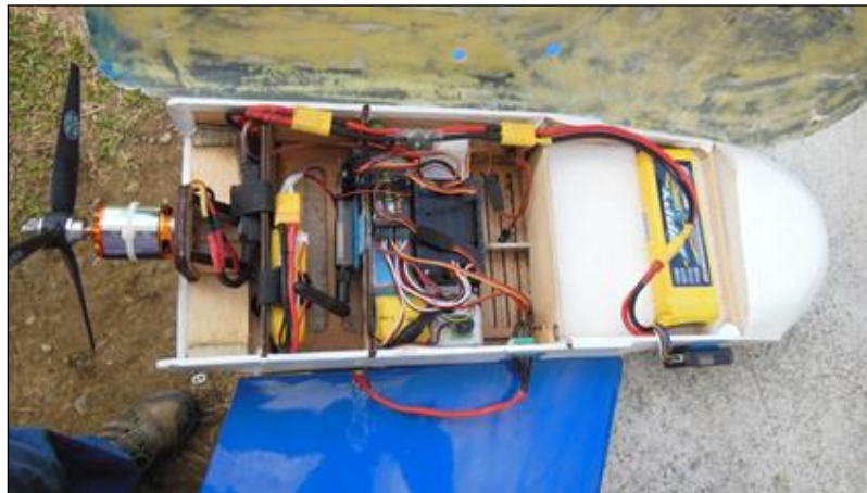
Figura 78. Distribución interna de los elementos de control y la planta motriz del modelo.
