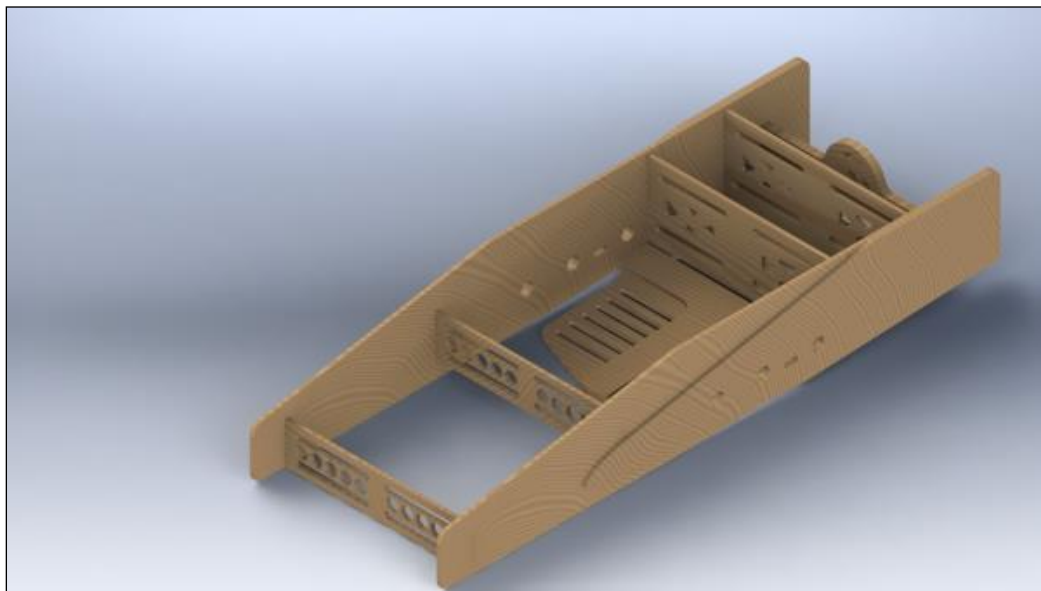
Figura 32. Modelado del fuselaje. Fuente: Autor
