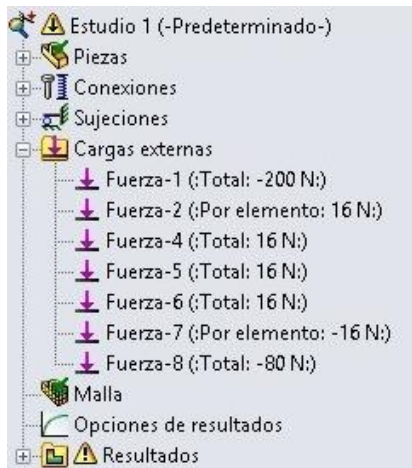
Figura 60. Cargas para simulación de elevación con fuerzas de 4G. Fuente: Autor
