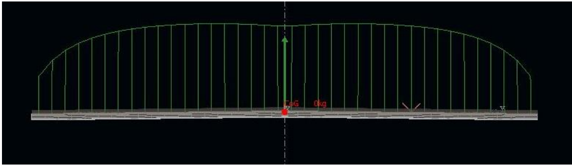
Figura 19. Distribución de los coeficientes de presión a lo largo del ala con diedro 0^\circ y wash in 0^\circ . Fuente: Autor
