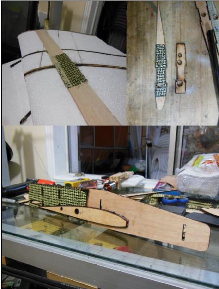
Figura 73. Refuerzo de la estructura con material compuesto. Fuente: Autor
