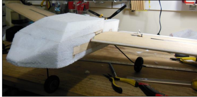
Figura 24. Fuselaje definitivo para el vuelo de prueba del concepto. Fuente: Autor
