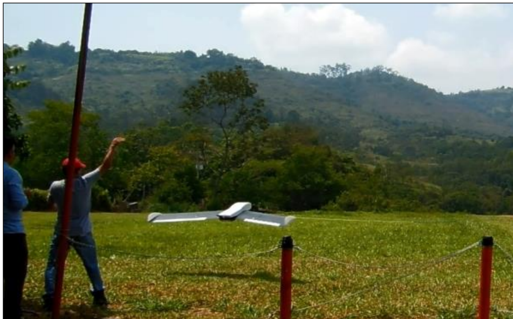
Figura 81. Lanzamiento del modelo Arpegio 2.4 para verificar el centro de gravedad. Fuente: Autor
