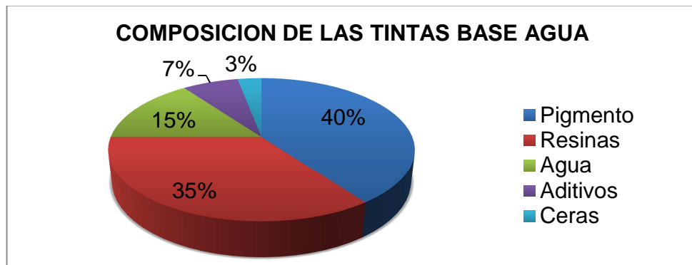
Figura 2. Composición de tintas base agua
