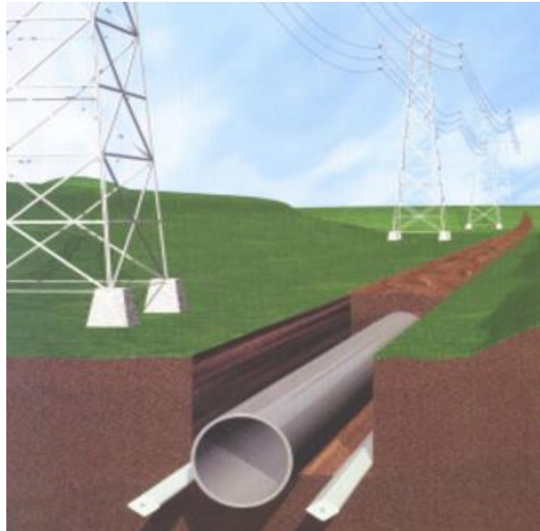
Figura 8. Línea de alta tensión y tubería compartiendo zona de servidumbre.
