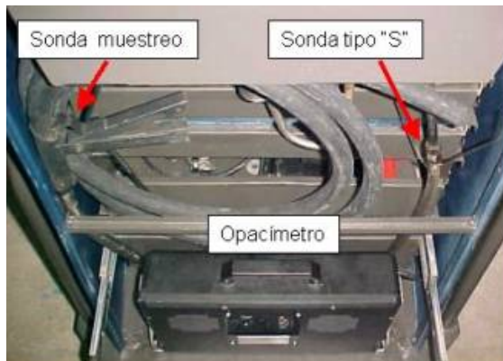
Figura 15. Parte posterior del prototipo DIAGMA D-100.
