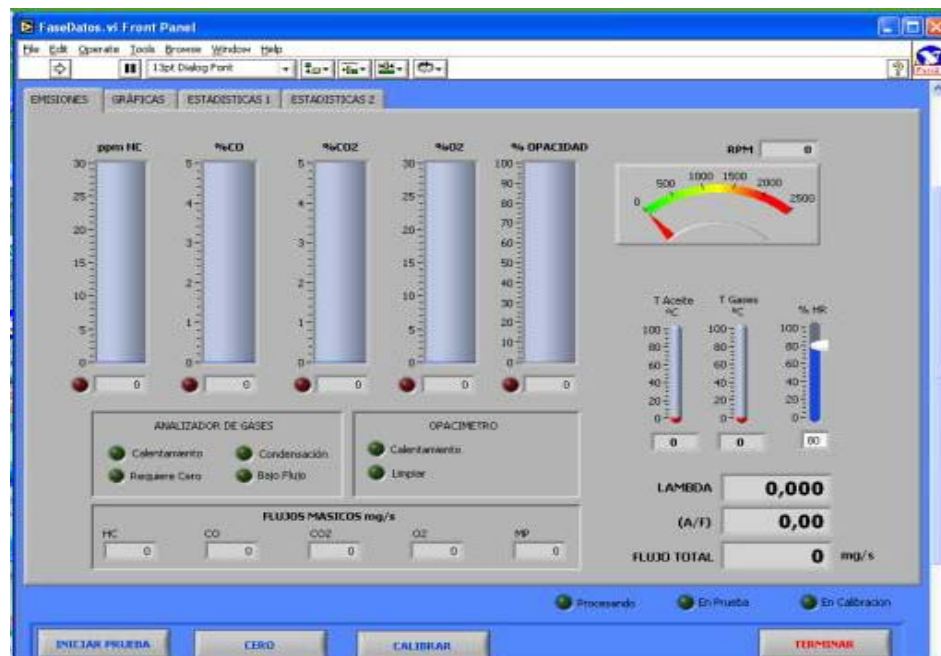
Figura 39. Panel principal de la técnica de análisis de gases y porcentaje de opacidad.
