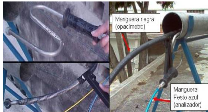
Figura 22. Sonda tipo S, sonda de muestreo y montaje.
