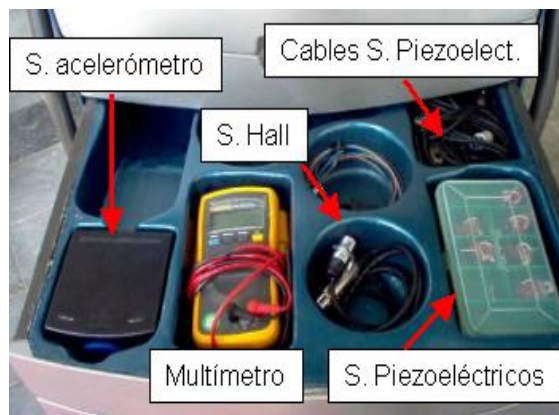
Figura 11. Cuarto nivel del prototipo DIAGMA D-100.
