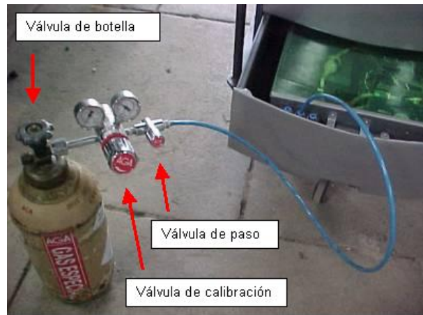
Figura 41. Calibración del analizador de gases.
