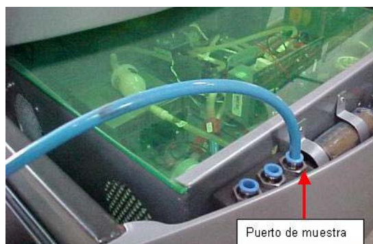
Figura 45. Conexión de la manguera Festo al puerto de muestra del analizador.
