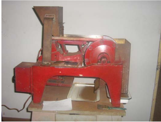
Figura C1. Fotografía del equipo utilizado para la separación magnética en vía seca
