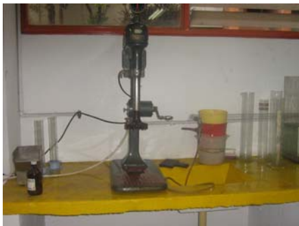
Celda de flotación
