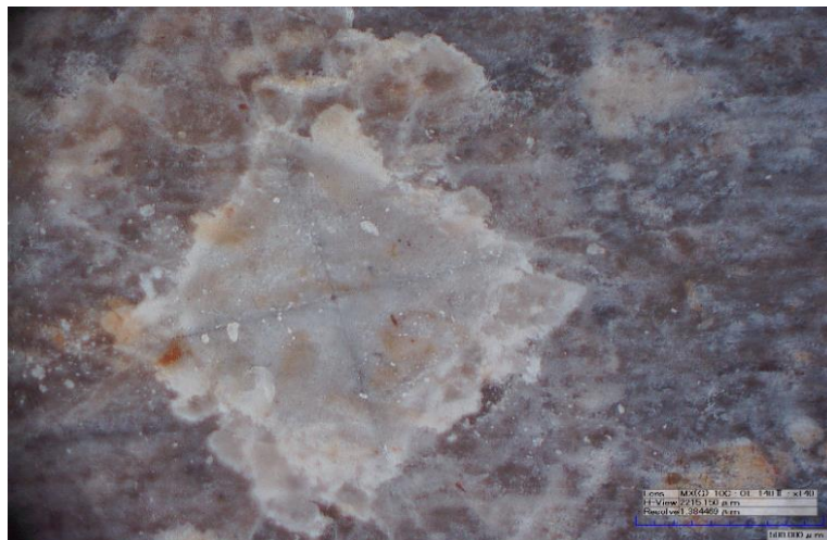
Figura 39. Huella Vickers en muestra Rosa blanca
