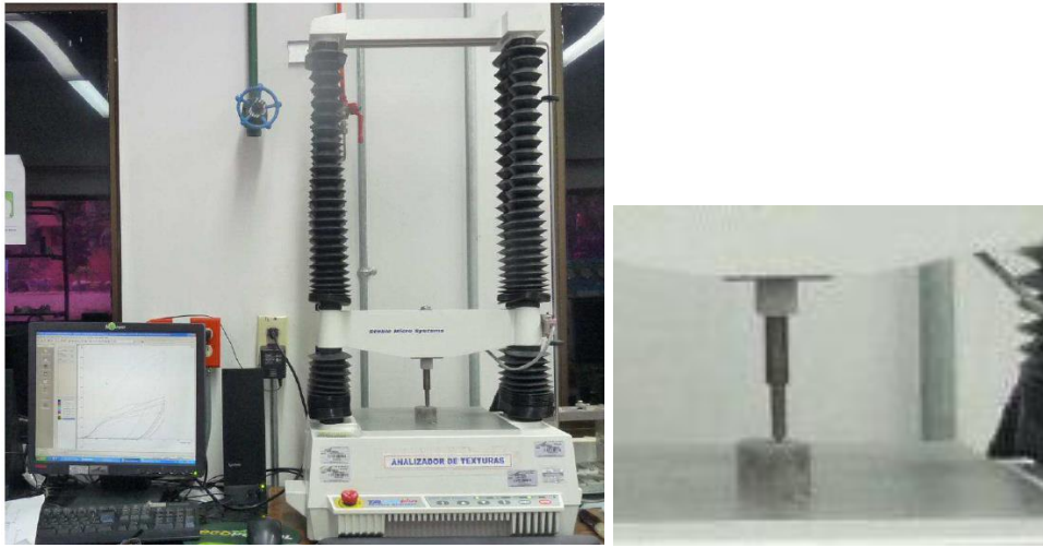
Figura 21. Analizador de texturas y acople punta Vickers
