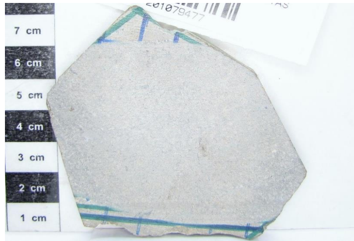
Figura 35. Muestra Rosa Blanca en condiciones necesarias para ensayo
