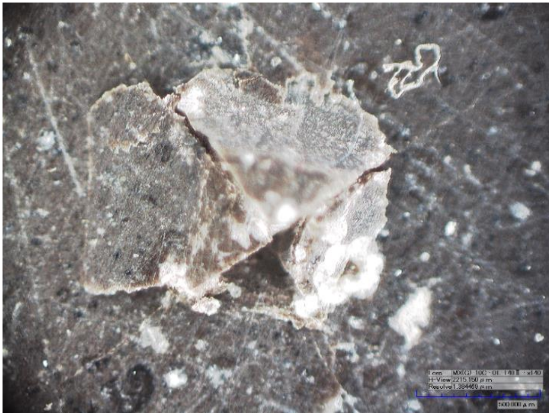
Figura 44. Huella Vickers en una muestra de la formación Luna 4 invalida por levantamiento
