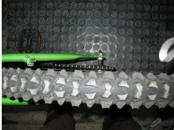
Figura 38 Apertura del tenedor trasero para colocar el separador.
