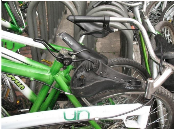
Figura 40 Rotura del soporte plástico del sillín
