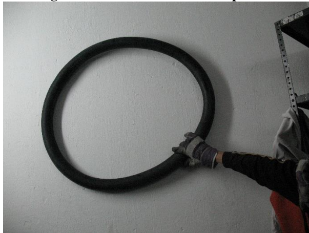
Figura 33 No uniformidad de las paredes
