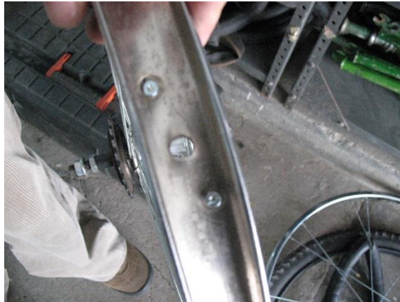
Figura 29 Agujeros de radios y válvula con rebaba cortante
