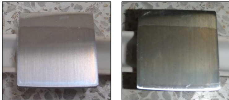
Figura 6. Recubrimientos de policaprolactona/quitosano sobre acero 316L
