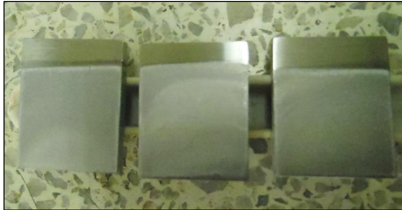
Figura 7. Recubrimientos de policaprolactona/quitosano/biovidrio sobre acero 316L
