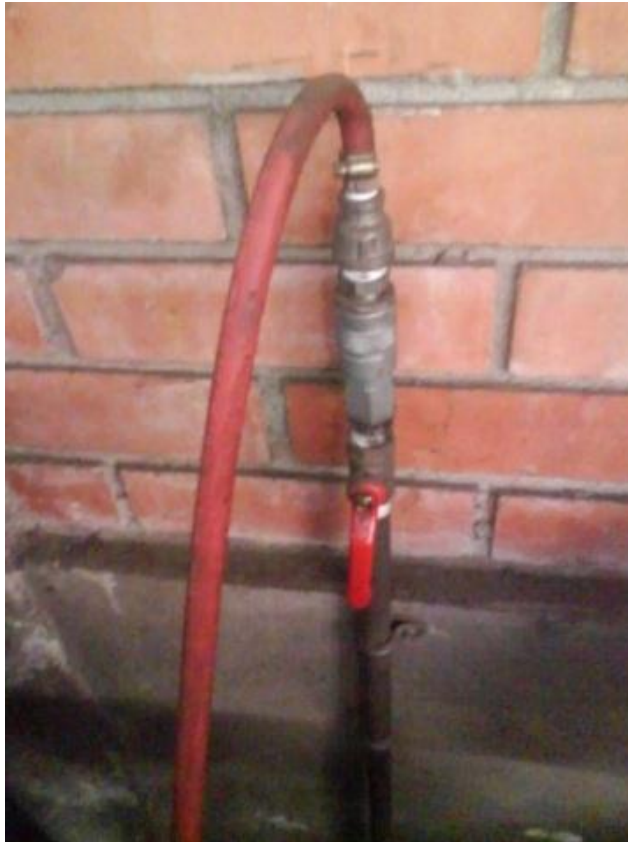
Figura 64. Manguera de limpieza torno CNC LEADWELL Fuga en acople
