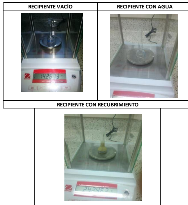
Figura 44. Cuarta prueba para encontrar el valor de la densidad de la mezcla
