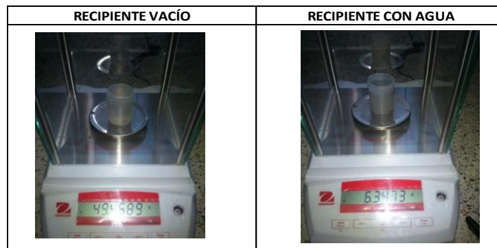
Figura 43. Tercera prueba para encontrar el valor de la densidad de la mezcla
