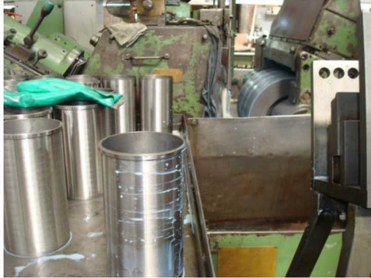
Figura 77. Rectificado de camisas
