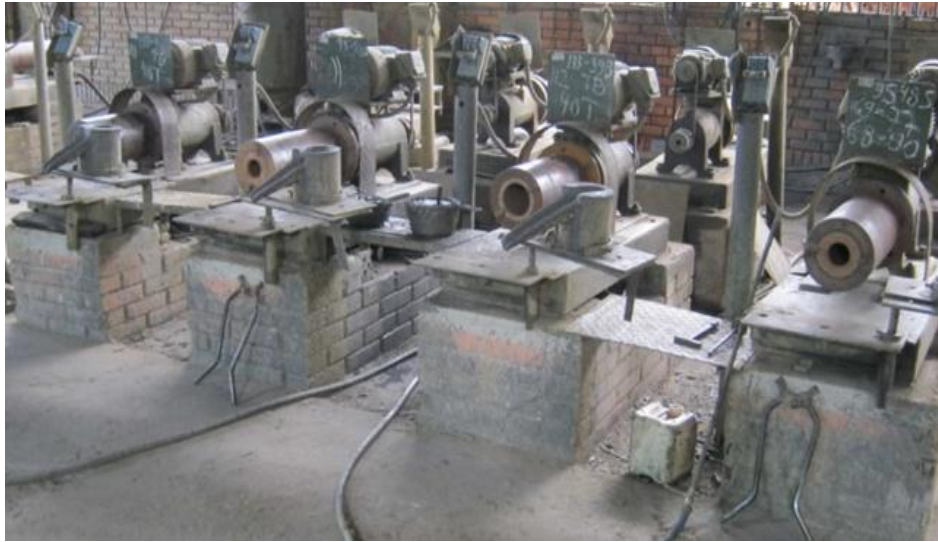
Figura 61. Sistema de coquillas de la planta de fundición
