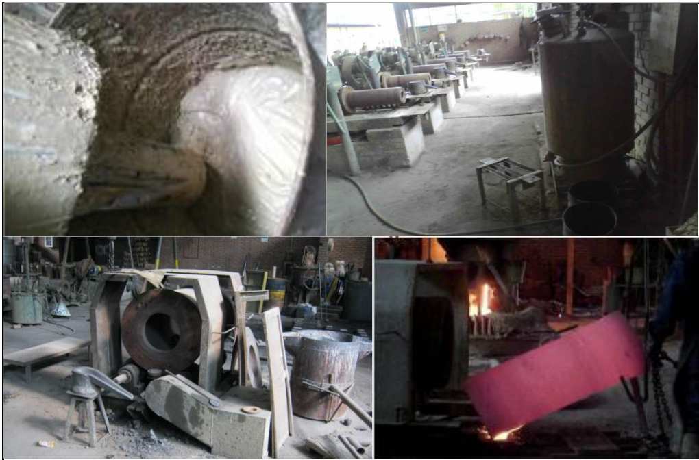
Figura 32. Fabricación, aplicación y extracción de tubos centrifugados tanque F025
