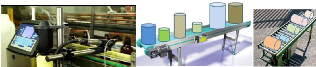
Figura 80. Representación esquemática de la ubicación de las camisas en la banda para el marcado con el equipo INKJET
