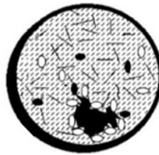
Figura 6. Fenómeno esférico coloidal debido al incremento en la concentración de parafinas.
