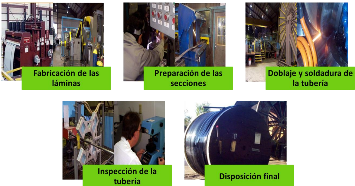
Figura 24. Construcción y fabricación del Coiled Tubing.
