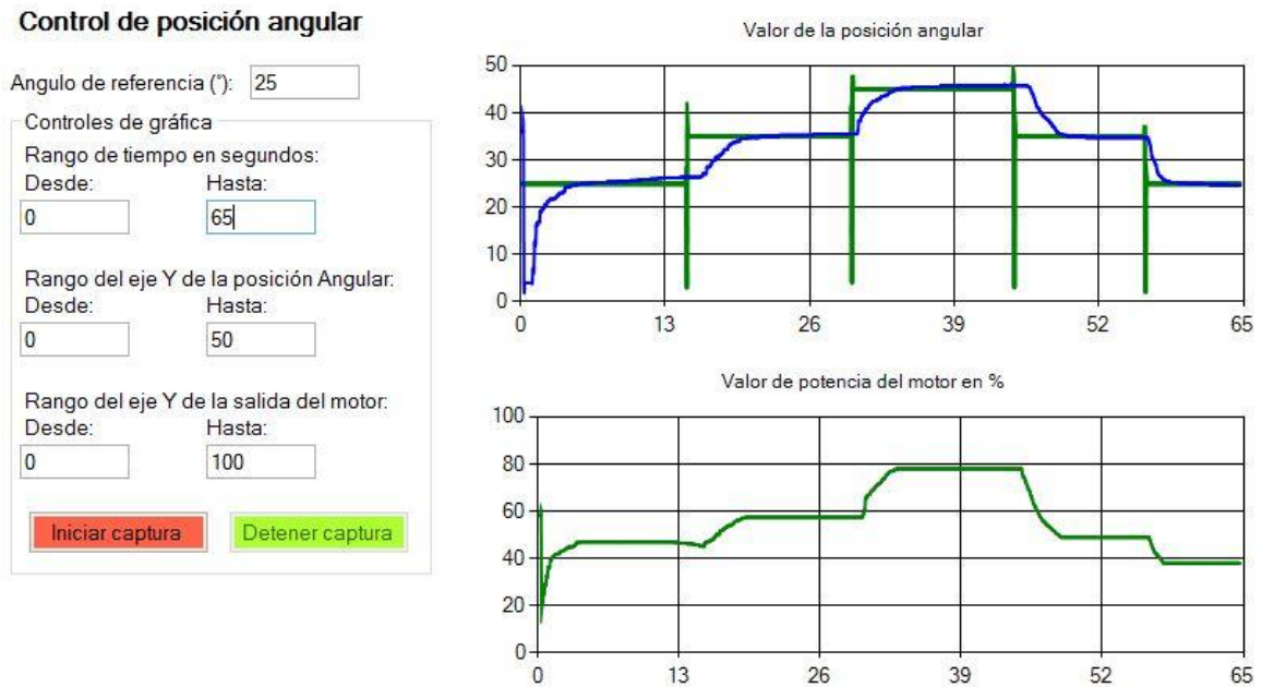
Figura 64. Ejecución de prueba de seguimiento para el sistema SISO.
