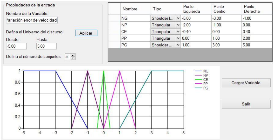
Figura 69. Definición de los conjuntos de la variable de entrada "Variación error de la velocidad".
