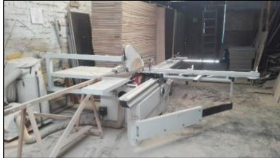
*Figura 23.* Máquina escuadradora (ocupa más del 50% del área a lo ancho e interrumpe el flujo de material en ocasiones) (Fuente: Registro fotográfico de la empresa)
