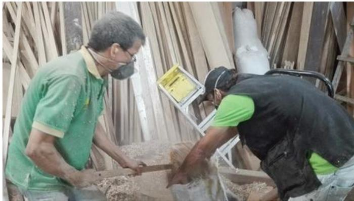
*Figura 36.* Uso de elementos de protección personal
