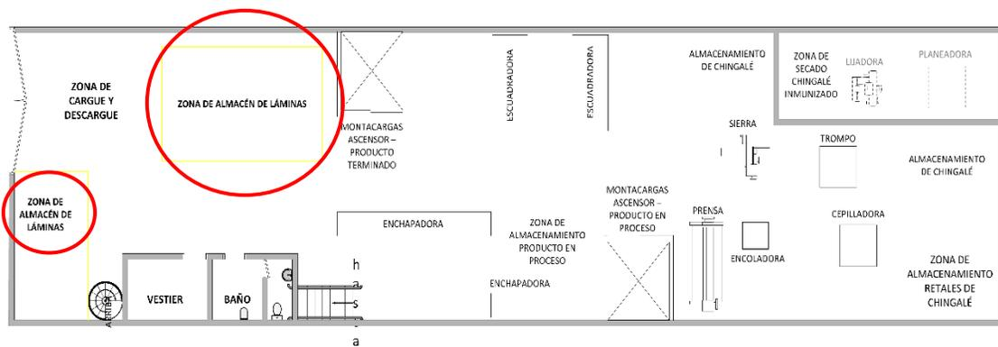
Figura 42. Plano y definición de zonas de almacenamiento de láminas (Fuente: Registro fotográfico de la empresa)
