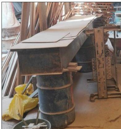
*Figura 9.* Inmunizador de madera (Fuente: Registro fotográfico de la empresa)
