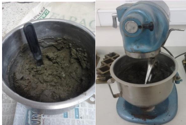
Figura 10. Mezcla de Mortero en la mezcladora
