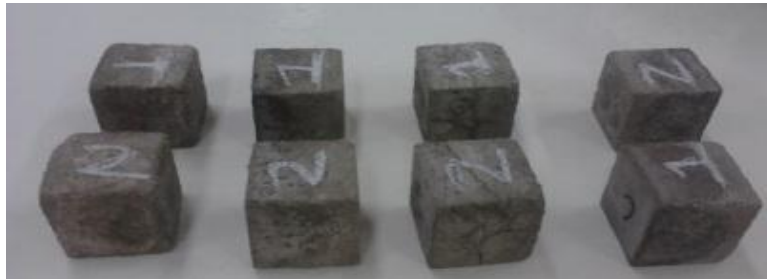
Figura 11. Resistencia Química de los agregados a los ataques con \text{Na}_2\text{SO}_4
