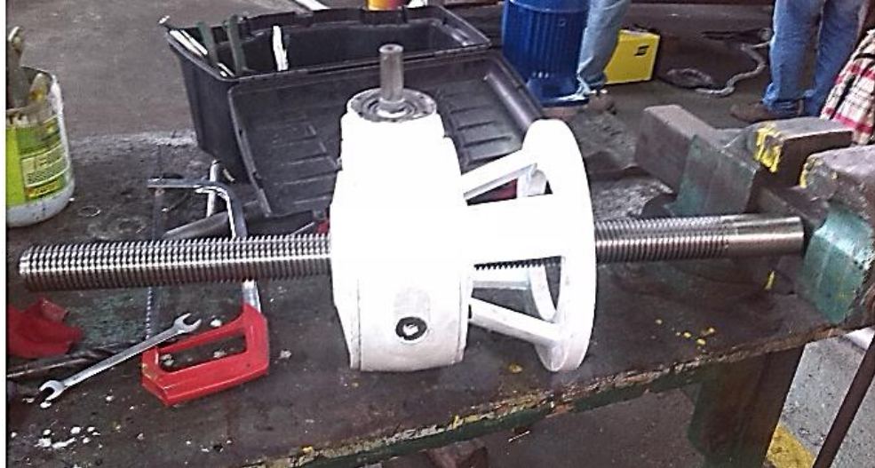
Figura 95: montaje en carcasa (sin fin corona), con tornillo de potencia
