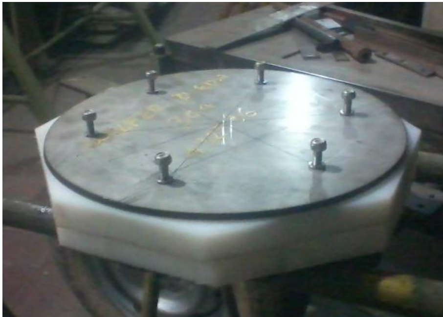
Figura 85: platinas de acero con centro en duralon
