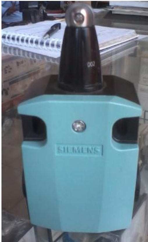
Figura 106: final de carrera usado en el sistema
