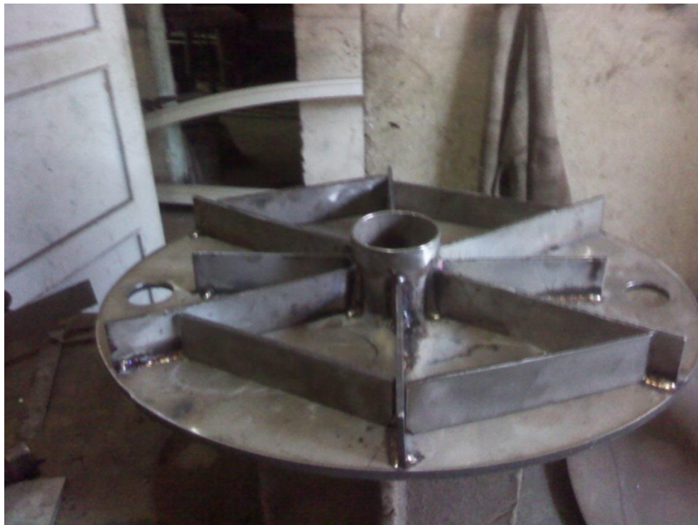
Figura 81: perfil inferior de 8 mm y refuerzos para tapa
