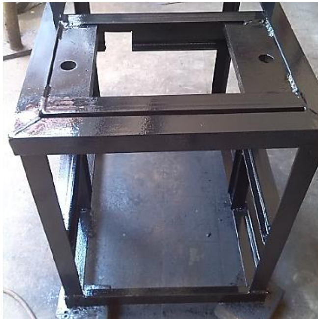
Figura 96: vista superior chasis soporte, agujeros para los pernos
