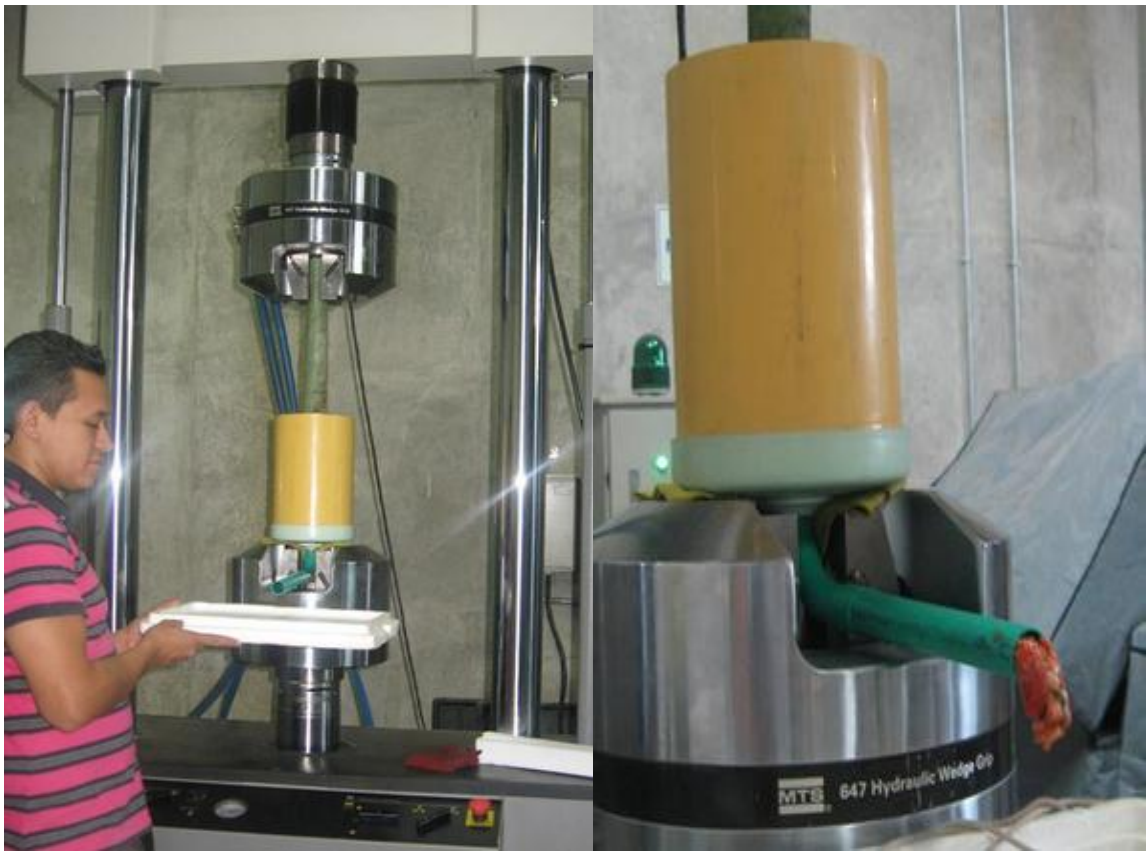
Figura 18: prueba con probeta en PVC
