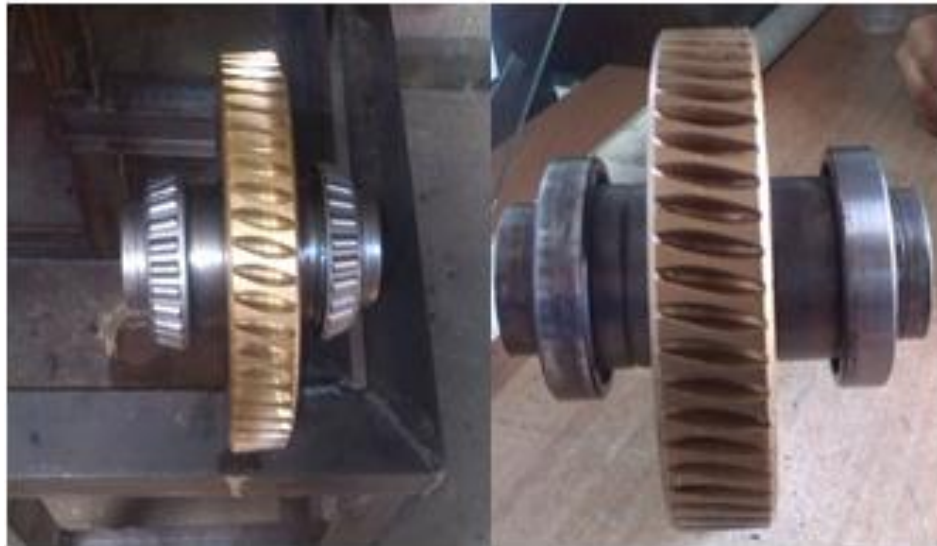
Figura 92: izquierda rodamientos axiales, derecha rodamientos radiales
