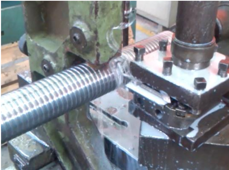
Figura 87: maquinado del tornillo de potencia
