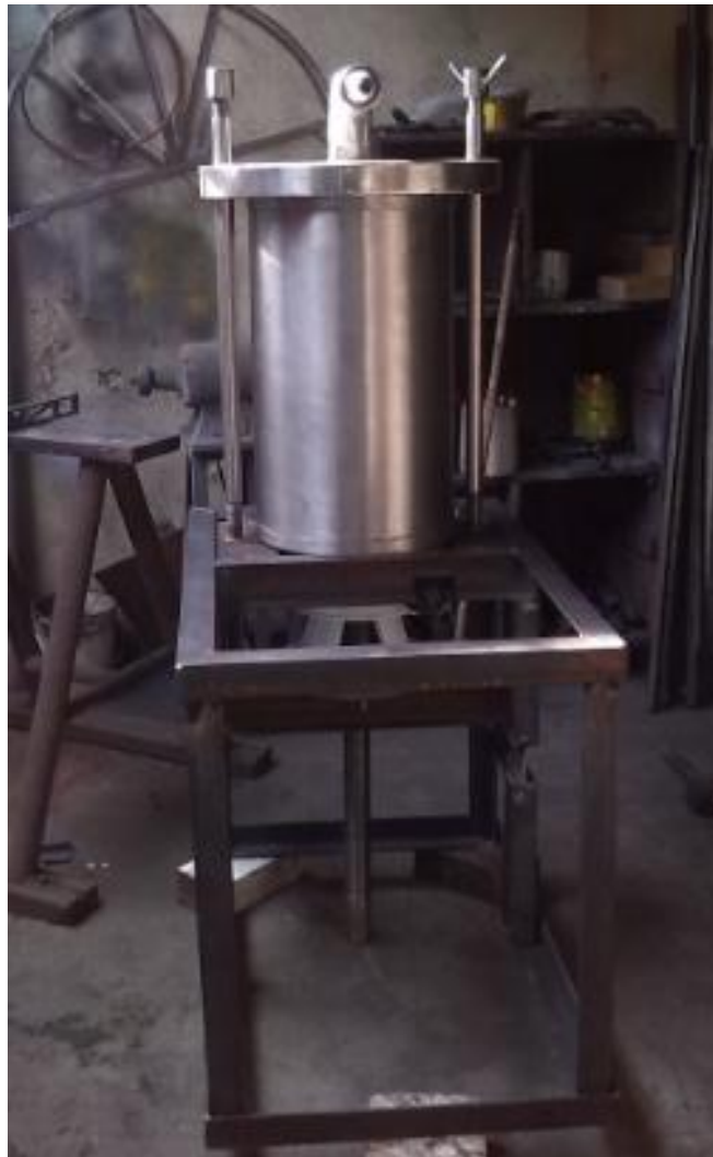
Figura 101: montaje cilindro y tapa boquilla en el chasis
