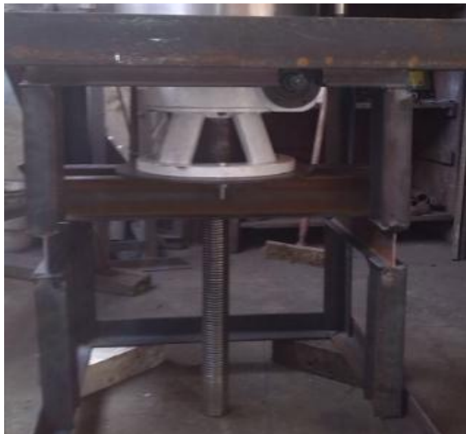
Figura 99: ensamble de carcasa sin fin corona en el chasis
