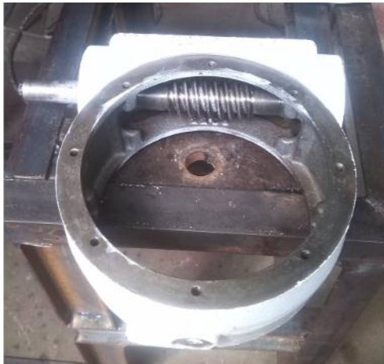
Figura 93: parte fija de la carcasa con montaje de tornillo sin fin
