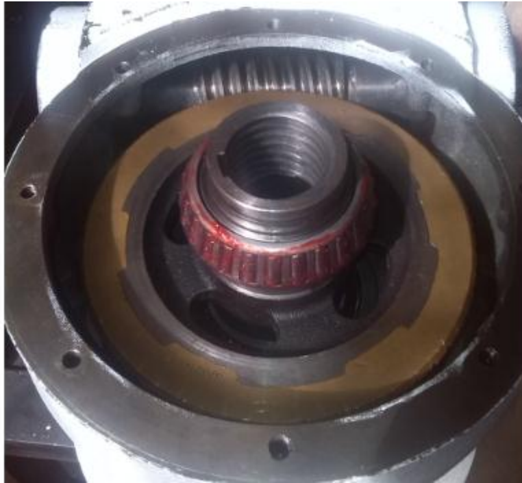
Figura 36: corona con rosca interna, sin fin y carcasa de mecanismo encontrado
