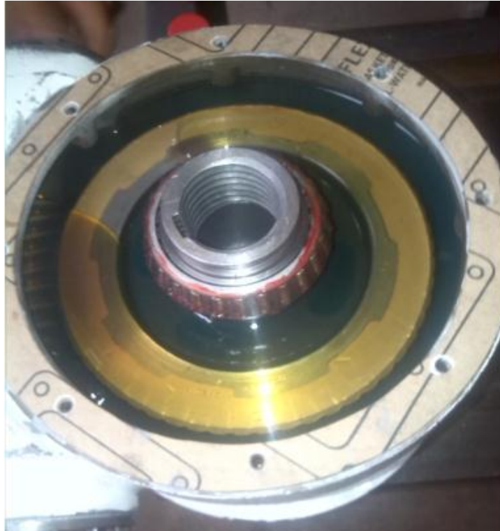
Figura 94: carcasa con llenado de valvulina y empaques nuevos
