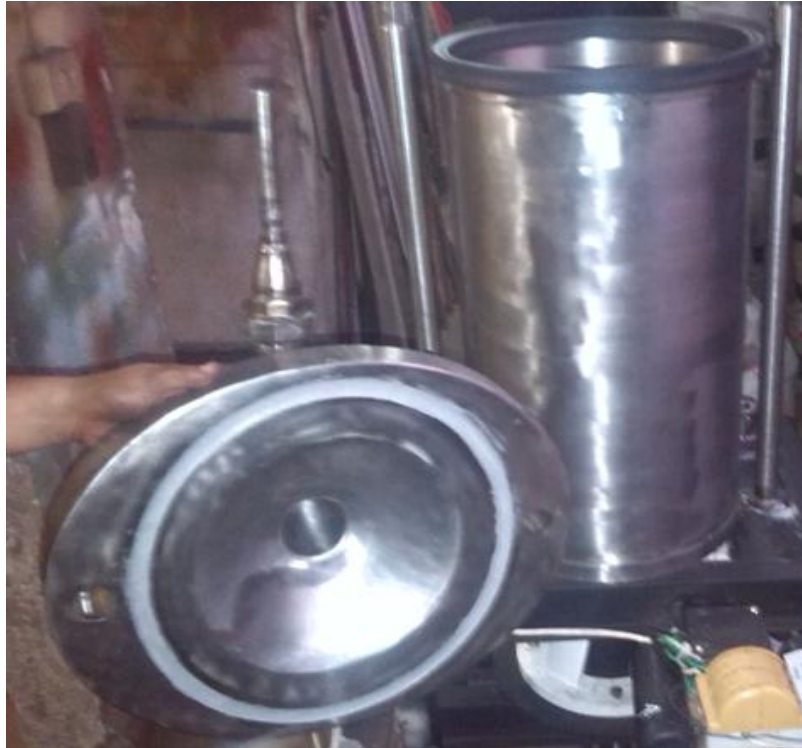
Figura 102: empaques en la tapa y cilindro
