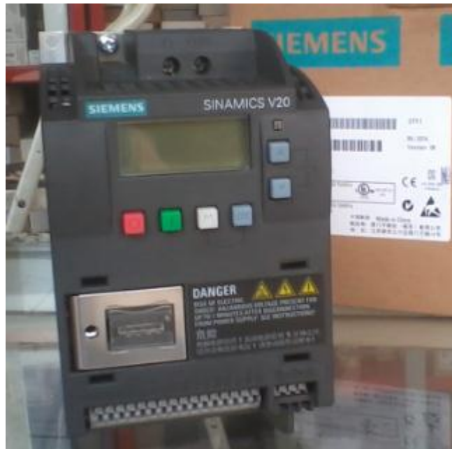
Figura 104: variador de velocidad V20 para 3 hp
