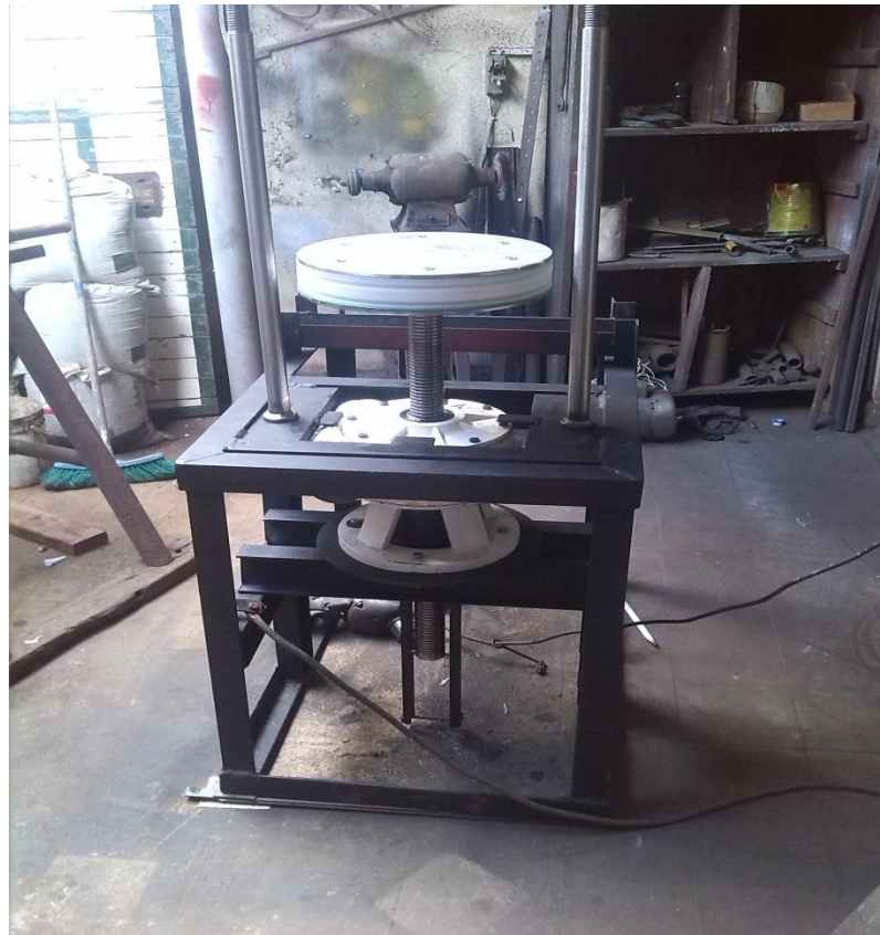
Figura 100: ensamble en el chasis, pernos, carcasa, tornillo de potencia y pistón
