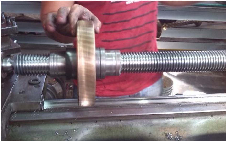
Figura 91: sentado de roscas corona y tornillo de potencia
