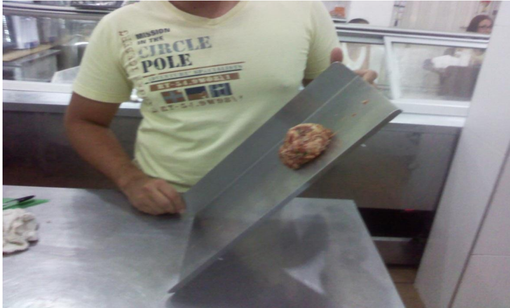
Figura 15: disposición prueba de fricción
