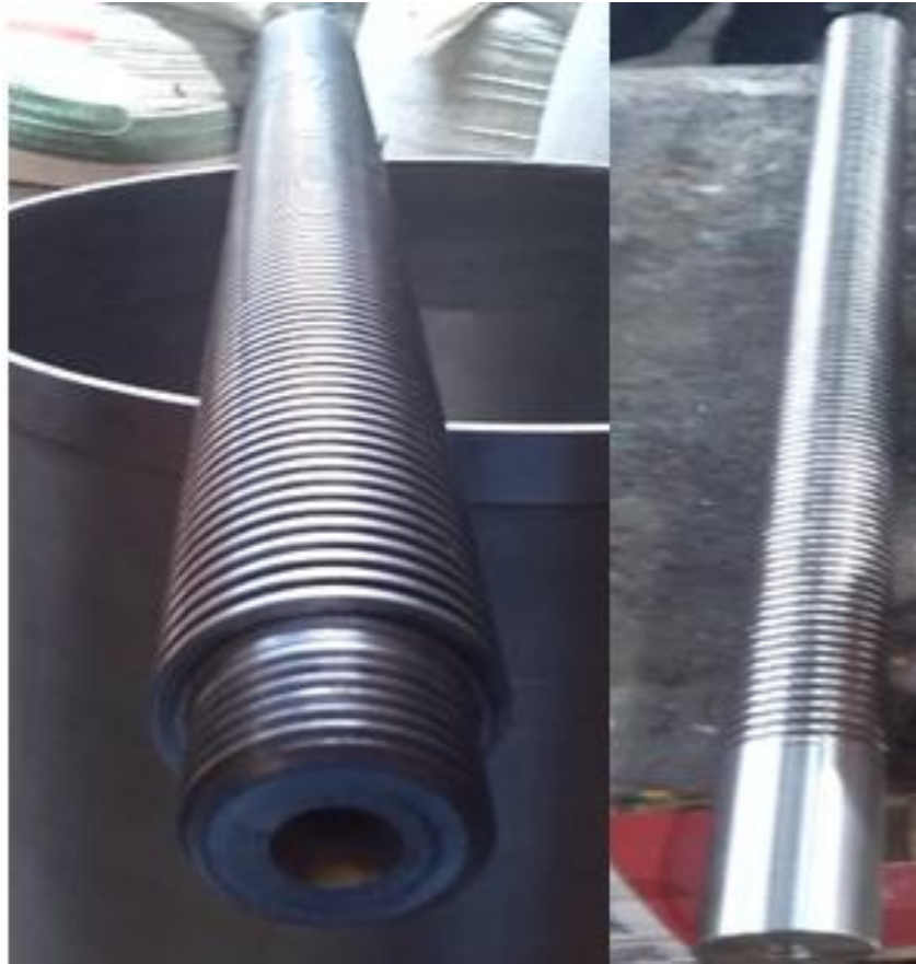
Figura 88: tornillo de potencia maquinado
