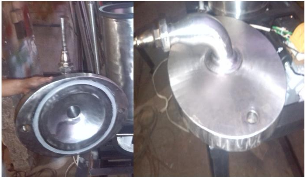
Figura 82: tapa terminada vista superior y inferior
