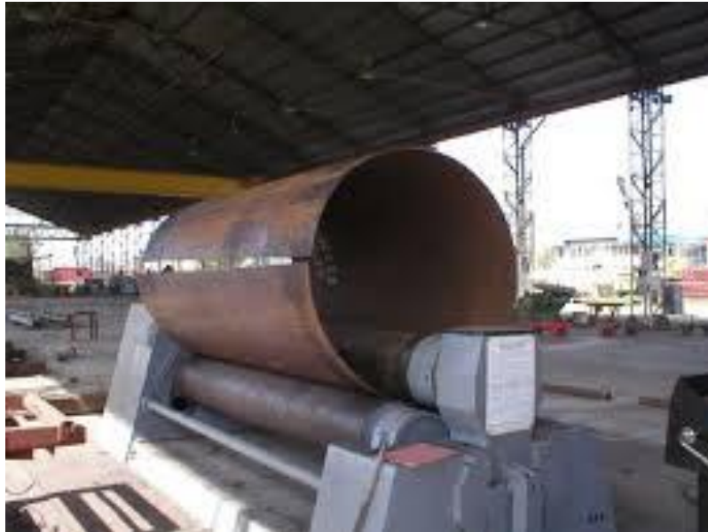
Figura 77: proceso de cilindrado común
