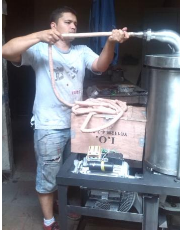
Figura 110: montaje de prueba con motor 3 hp a 1800 RPM
