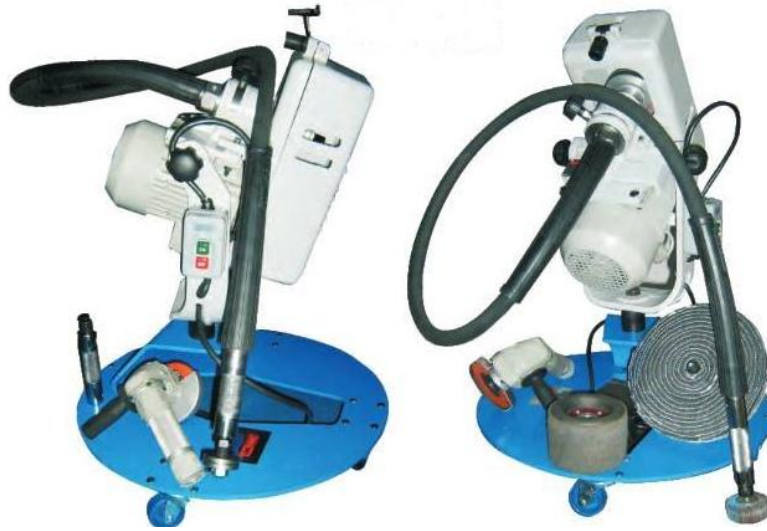
Figura 79: Rotosfera, maquina especial para pulimento de acero inox
