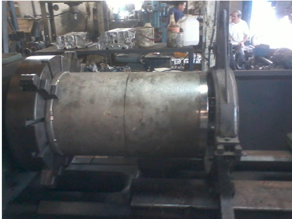
Figura 78: refrentado de las caras del cilindro
