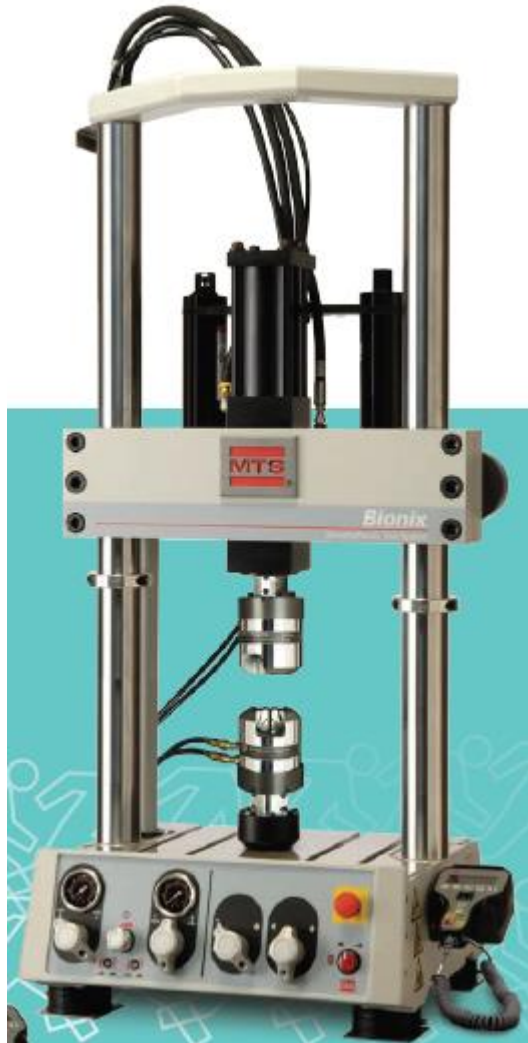
Figura 17. Máquina universal MTS 515.11.
