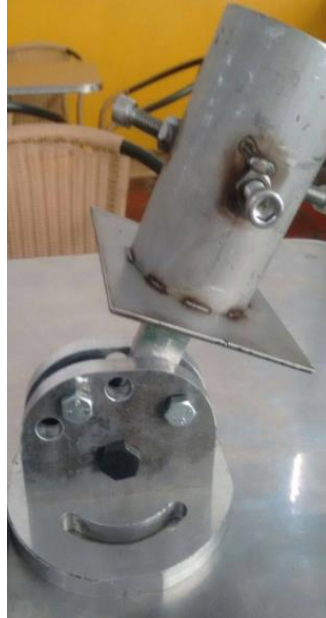
Figura 21. Ángulo de 75° en el anclaje inferior.
