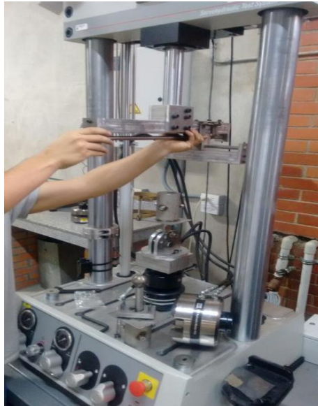
Figura 19. Prueba de compresión en la rodilla.
