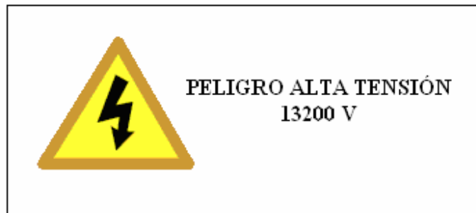
Figura 5.1 Señal informativa para alimentador en MT
