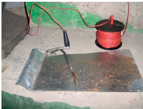
Figura 2.11 Conexión de electrodos para medida de PT
